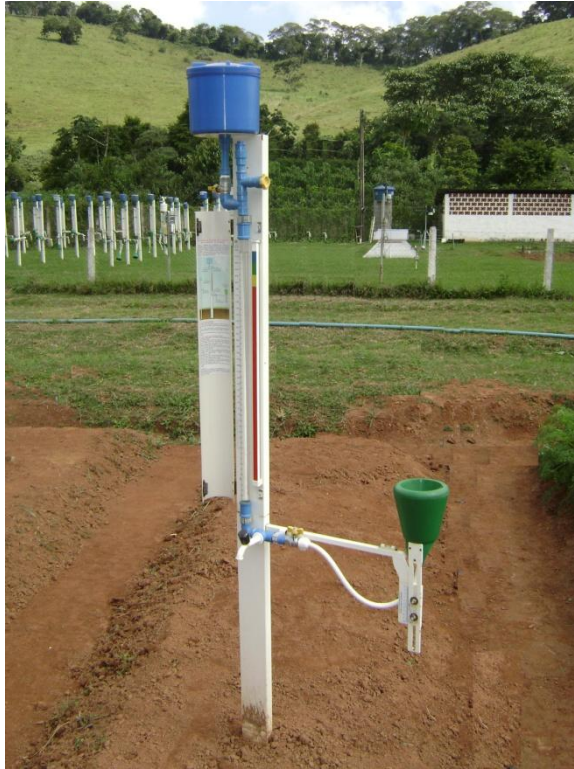
Figura 5 - Irrigâmetro usado no experimento.
