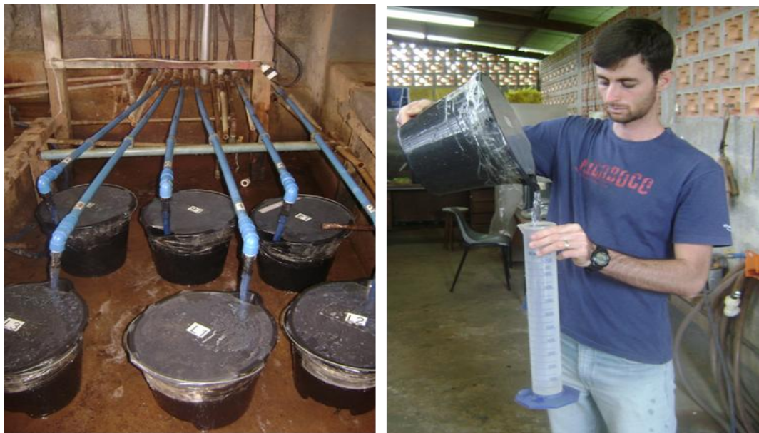
Figura 12 - Baldes utilizados na coleta da água e medição do volume de drenagem.
