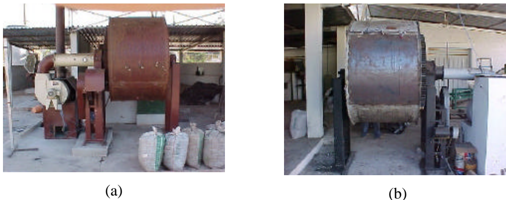
Figura 2 – Secador rotativo comercial (a) e modificado (b).
