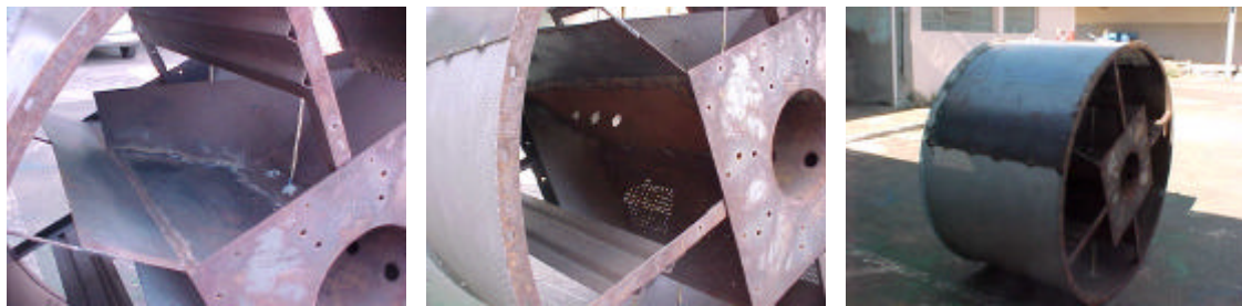
Figura 4 – Detalhes das modificações ocorridas no secador rotativo
