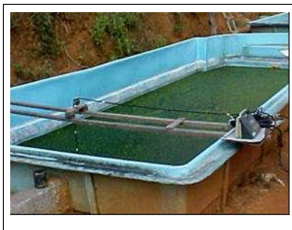
Figura 4.5 – Ilustração do aparato para as medidas de OD com a sonda de profundidade.
