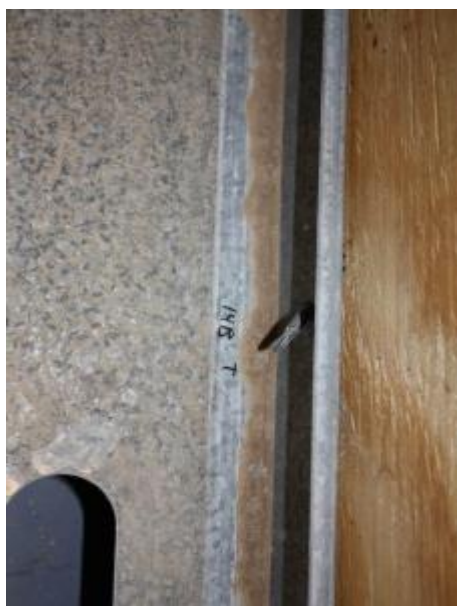
Figura 2.10 – Falha por screw tilting observada nos modelos ensaiados por Northcutt (2012)
