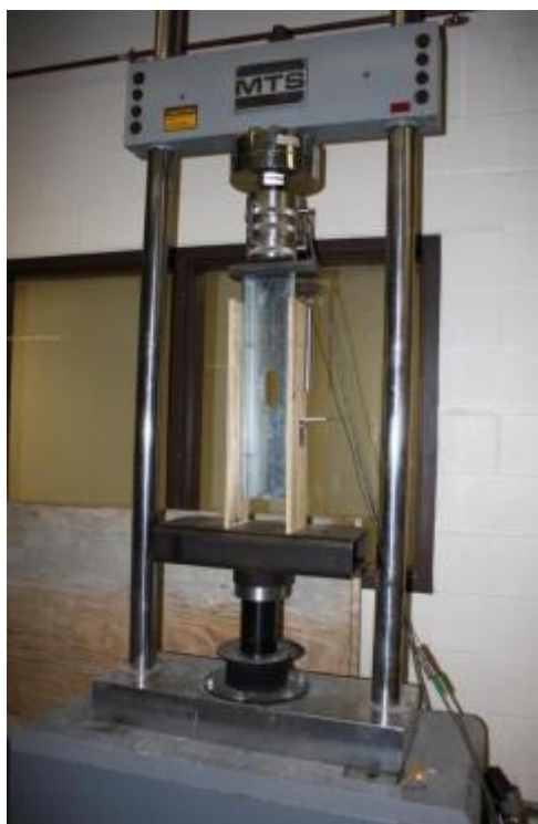
Figura 2.9 – Aspecto geral dos ensaios push-out realizados por Northcutt (2012)
