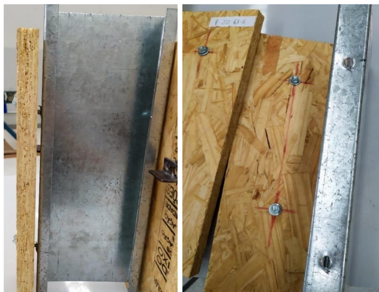
Figura 4.67 – Rasgamento do perfil de aço na região de ligação após a falha da amostra P-200-55-A
