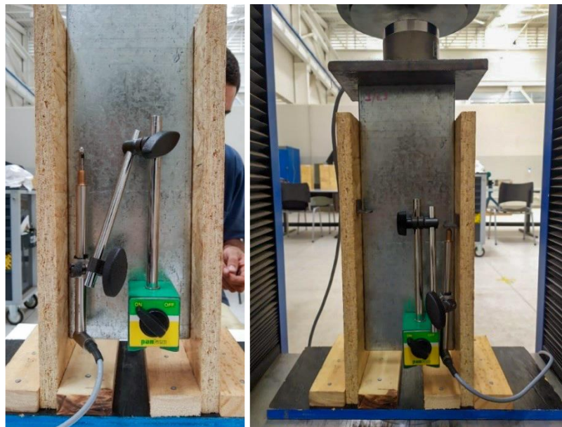
Figura 3.14 – Instrumentação do “Lado Fechado - LF” da amostra
