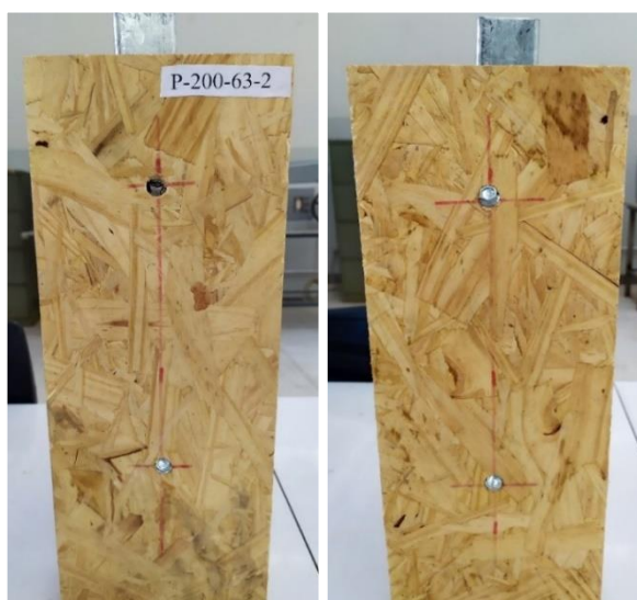
Figura 4.60 – Vistas laterais da amostra P-200-63-2 após a falha
