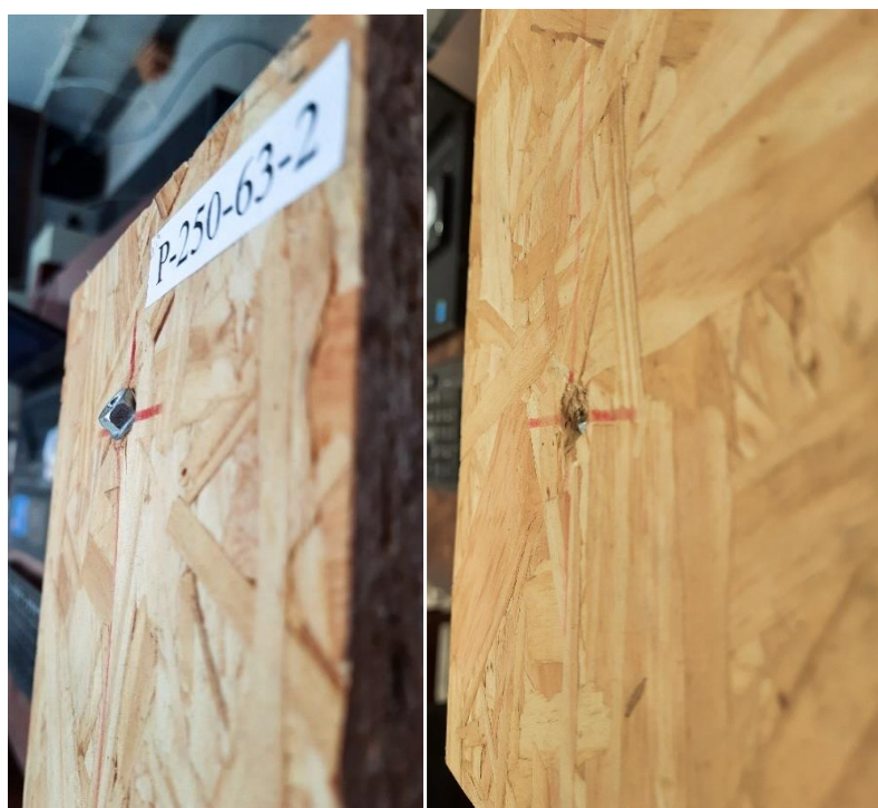
Figura 4.64 – Detalhe da região de ligação dos parafusos superiores da amostra P-250-63-2 após a falha
