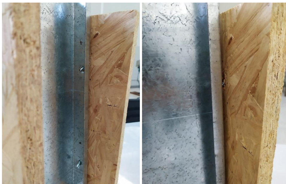
Figura 4.62 – Zonas afetadas pelo esmagamento nas placas de OSB para a amostra P-200-63-2 após a falha
