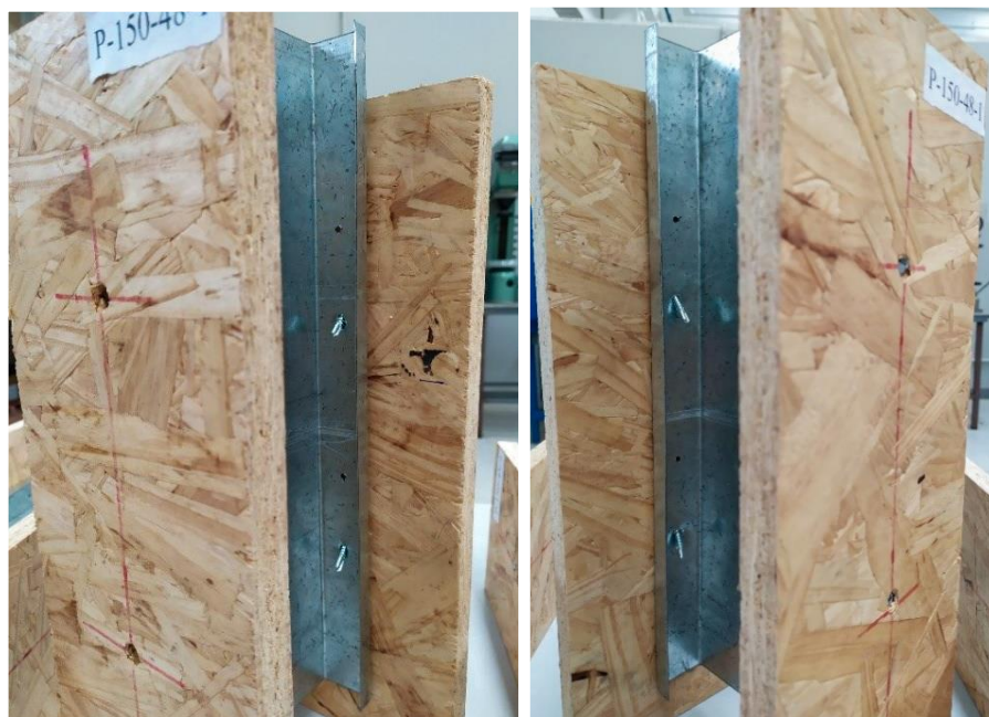
Figura 4.55 – Aspecto geral da amostra P-150-55-1 após a falha
