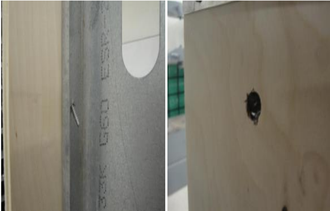
Figura 2.12 – Falha por screw tilting observada nos modelos ensaiados por Martin (2014)
