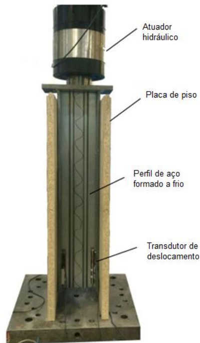
Figura 2.25 – Configuração geral de um ensaio push-out realizado por Kyvelou (2017)
