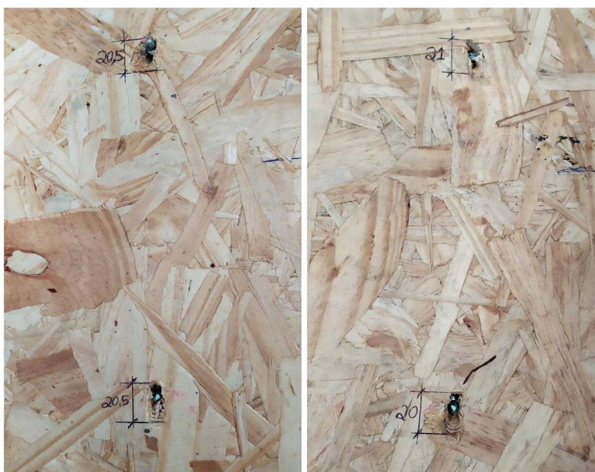
Figura 4.62 – Zonas afetadas pelo esmagamento nas placas de OSB para a amostra P-200-63-2 após a falha
