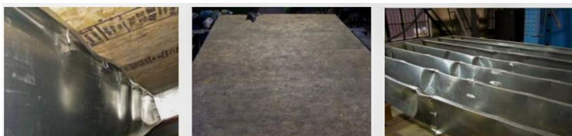
Figura 2.15 – Modos de falha observados nos ensaios de Zhou et al. (2014)
