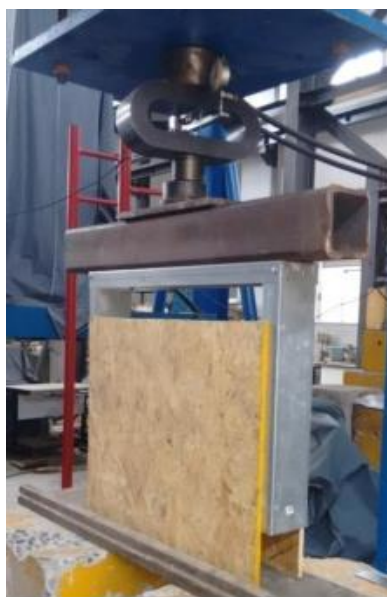
Figura 2.17 – Aspecto geral dos ensaios push-out realizados por Villela (2016)
