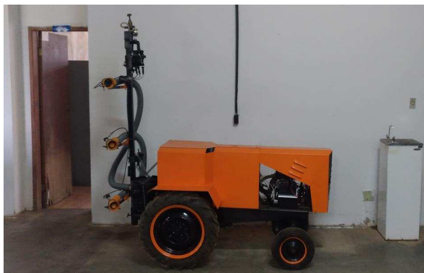
Figura 4 – Pulverizador pneumático autopropelido revestido com carenagem e barra de pulverização vertical.
