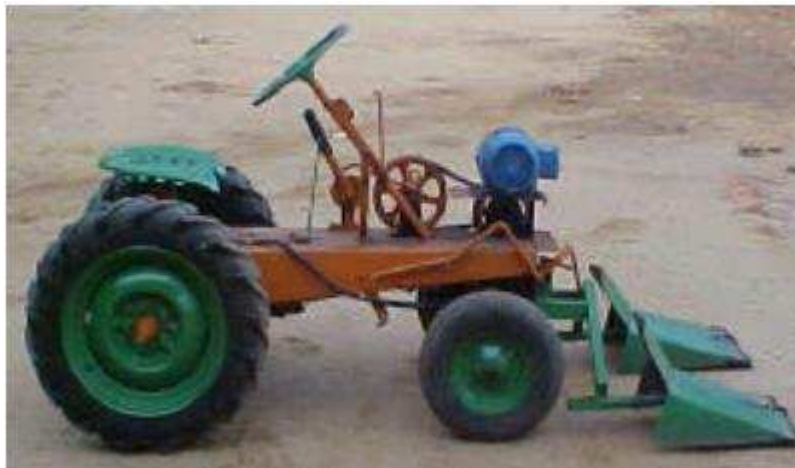
Figura 1 – Microtrator utilizado para confecção do pulverizador pneumático autopropelido (RODRIGUES, 2005).
