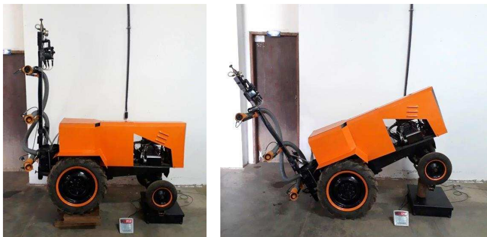
Figura 14 – Determinação do centro de gravidade do pulverizador pneumático autopropelido.
