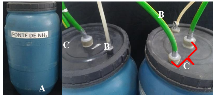
Figura 3. Recipientes polietileno de alta densidade que constituíram o reator de amonificação (A), entrada de ar (B), e saída do ar-NH 3 dos reatores (C).
