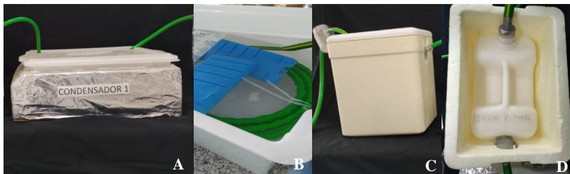
Figura 4. Sistema desumidificador composto por: câmara de resfriamento (A) com detalhe do interior com mangueira enrolada e bolsas de gelo imersos em água (B), câmara de condensação (C) com detalhe do recipiente de coleta da água condensada (D).
