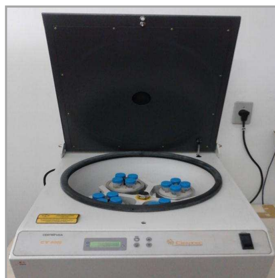
Figura 6 – Centrifugação das amostras em centrífuga CIENTEC CT 6000.
