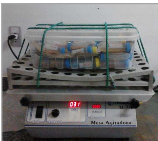
Figura 5 – Agitação das amostras em mesa agitadora orbital TECNAL TE-140.
