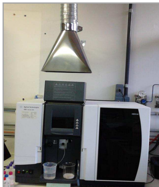
Figura 8 – Espectrofotômetro de absorção atômica utilizado para leitura das concentrações dos metais em solução.
