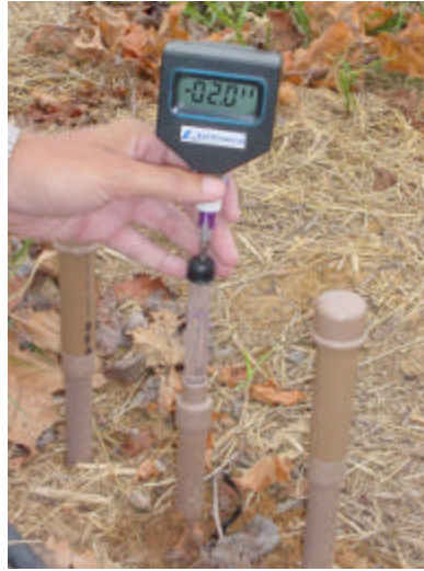
Figura 14 – Detalhe da leitura dos tensiômetros com tensímetro digital.
