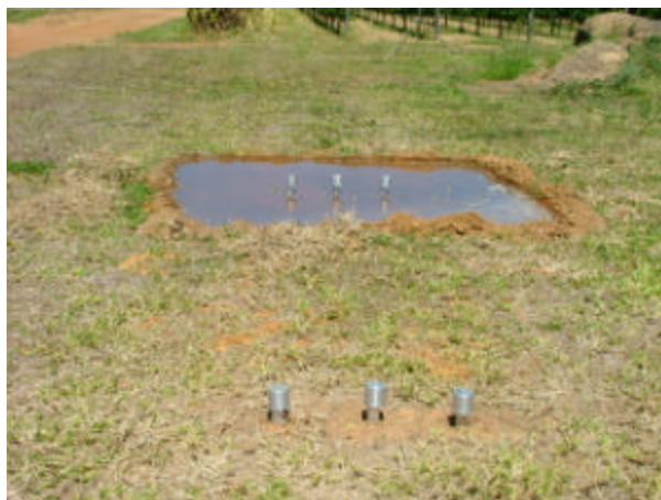
Figura 13 – Parcelas seca e umedecida, usadas para calibração da sonda de nêutrons, próximas ao local do experimento no Campo Experimental de Bebedouro em Petrolina-PE.
