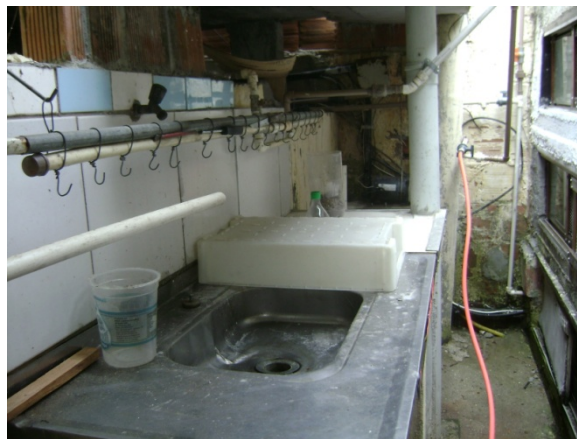
Figura 11: Local de abate no quintal do produtor, com nória de arame, apresentando pontos de ferrugem. Em frente existiam baias de criação, não havia água clorada, o local de abate não dispunha de teto, além de não disporem de material adequado para higienização e guarda de utensílios. O local apresentava instalações, equipamentos e utensílios inadequados, colocando em risco a saúde da população.
