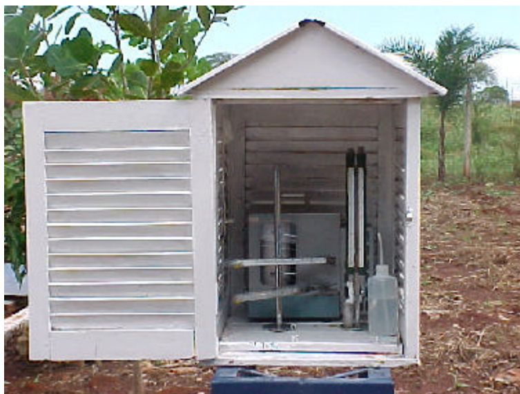
Figura 5 – Abrigo meteorológico com termoigrógrafo e psicrômetro.
