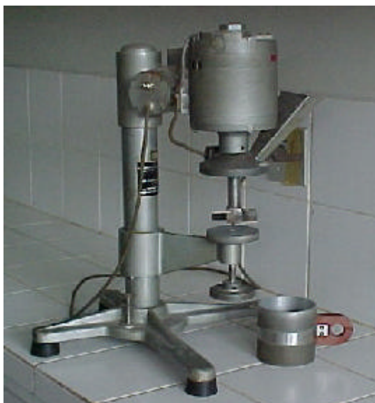
Figura 13 – “Stein Breakage Tester” utilizado para os testes de suscetibilidade a quebras.
