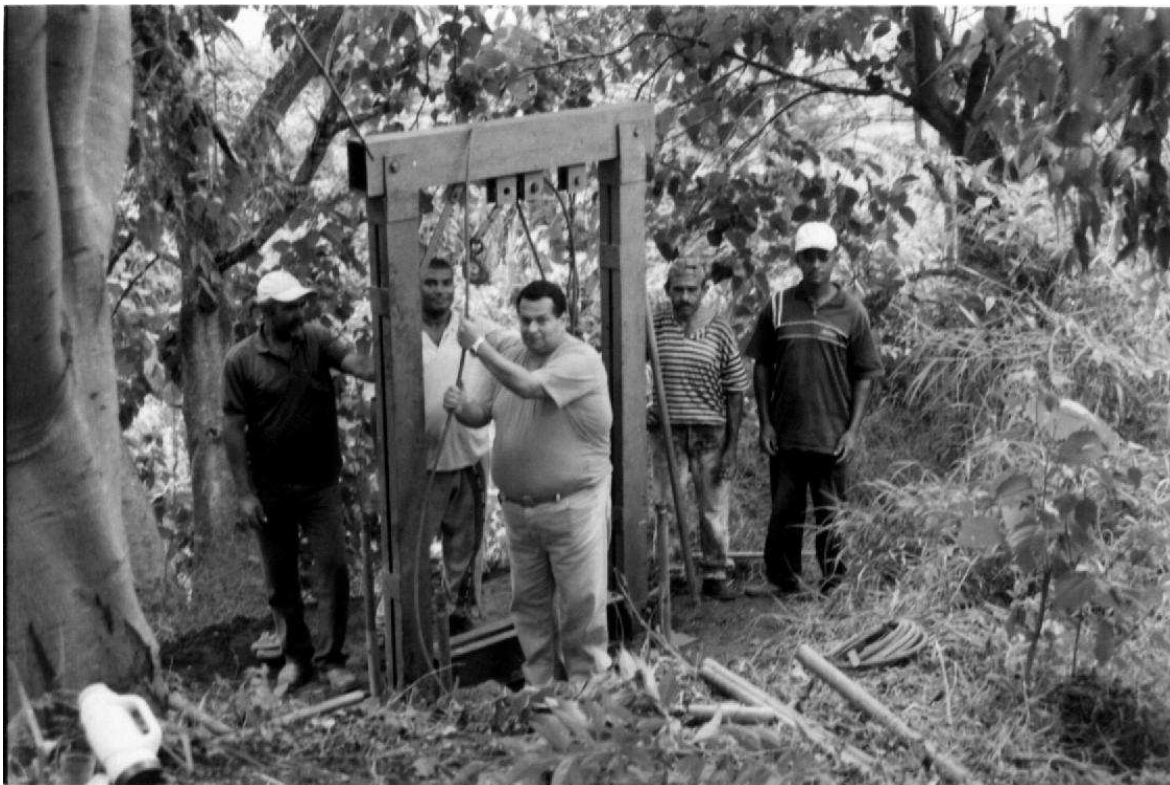
-Figura 25, sistema de execução de um ensaio dilatométrico.
