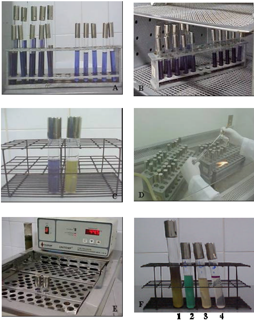
Figura 15 – Etapas de análise para identificação de coliformes pela técnica dos tubos múltiplos. (A) Seqüência de tubos utilizados. (B) Incubação a 37°C. (C) Resultado da análise presuntiva para coliformes totais: negativo no tubo à esquerda e positivo no tubo à direita. (D) Repique dos tubos positivos para análise de coliformes totais, termotolerantes e Escherichia coli . (E). Incubação em banho-maria a 44,5°C. (F) Resultados positivos: presuntivo para coliformes totais (tubo 1), confirmativo para coliformes totais (tubo 2), coliformes termotolerantes (tubo 3) e Escherichia coli (tubo 4).
