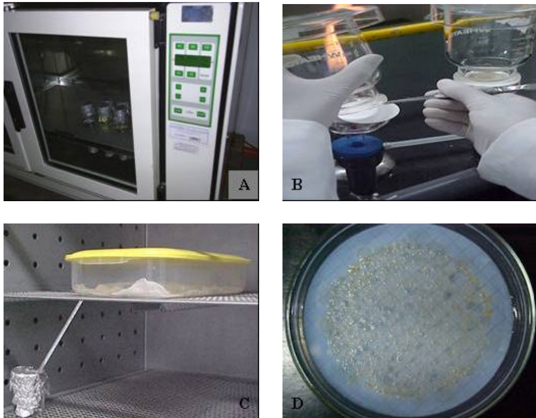
Figura 16 – Etapas de análise para identificação de esporos aeróbios pela técnica da membrana filtrante. A) Tratamento das amostras em agitador; B) Filtração da amostra; C) Incubação em câmara úmida a 37 °C; D) Placas com crescimento de UFC, após 24 horas de incubação.
