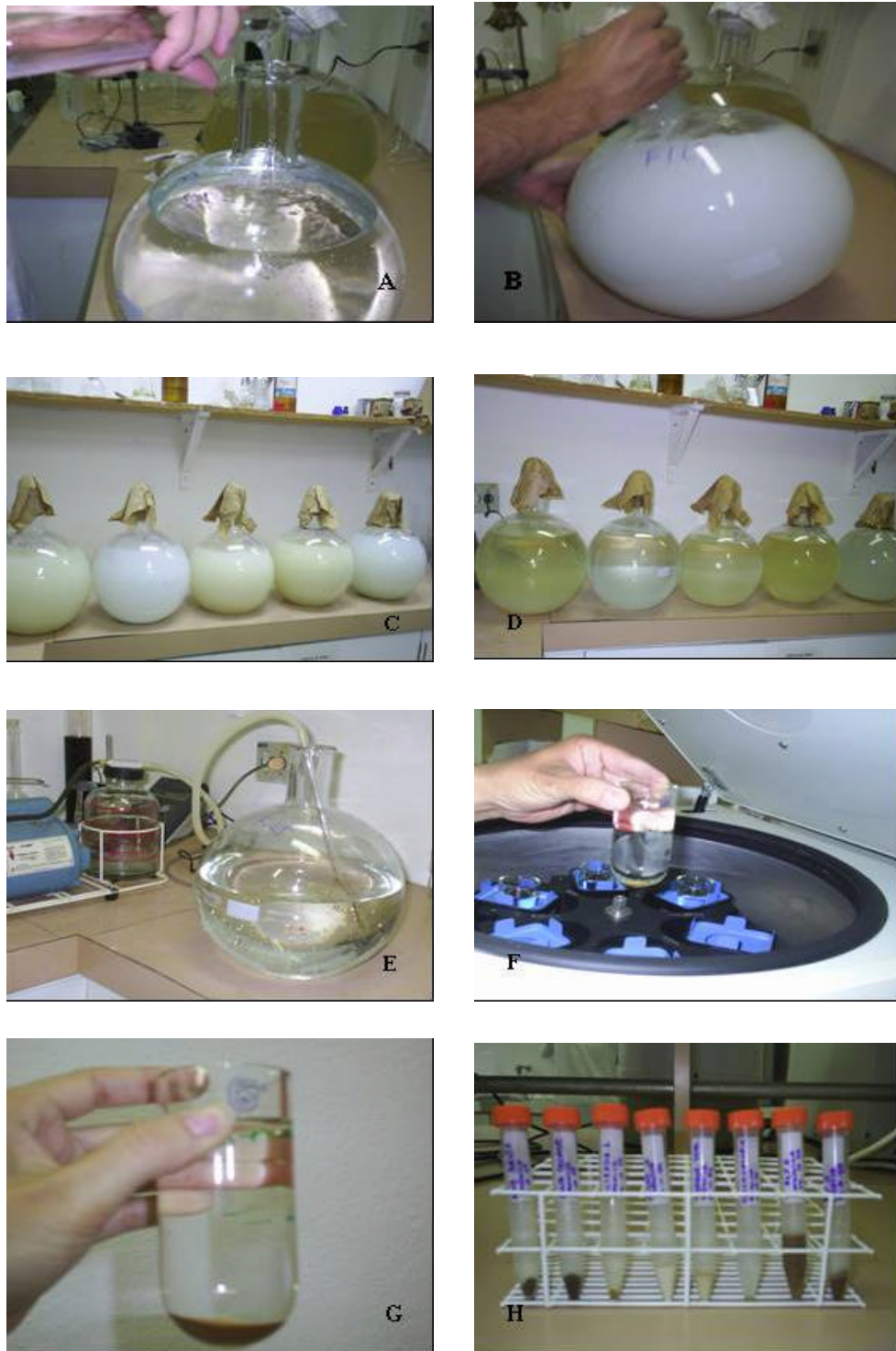
Figura 20 – Preparo de amostras para identificação de (oo)cistos de protozoários por imunofloreescência. (A) Adição dos reagentes. (B) Homogeneização. (C) Amostras antes e (D) após a sedimentação. (E) Aspiração do sobrenadante. (F) Centrifugação. (G) Sedimento formado. (H) Amostras concentradas prontas para análise de imunofluorescência.
