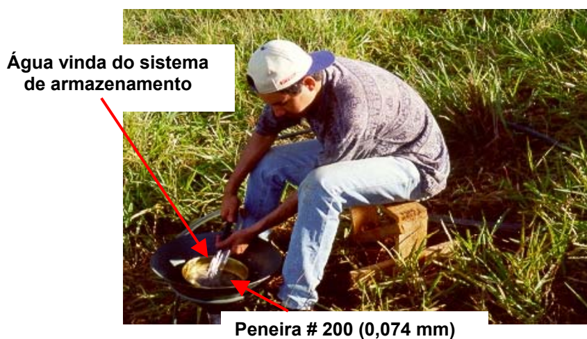
Figura 24. Peneiramento, em peneira de malha 200, dos sedimentos erodidos no canal.
