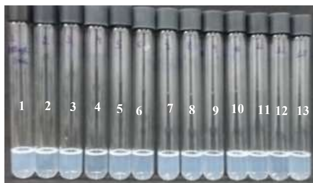
Figura 2B. Imagem das nanoemulsões* dispersas na água desionizada antes da análise de turbidez.
