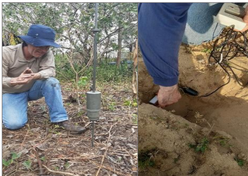
Figura 2 – Análise da resistência a penetração (RP) com penetrômetro de impacto e obtenção da umidade e temperatura in situ até a profundidade de 60 cm em Tucano, BA Set/21
