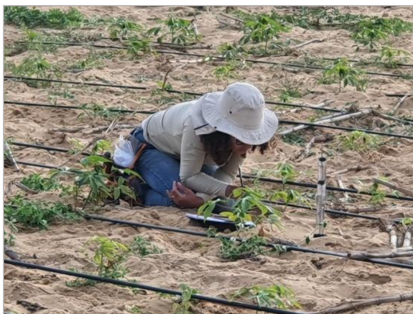
Figura 3 – Análise da condutividade hidráulica não saturada com o uso de um Mini Disk infiltrometer in situ em Tucano, BA Set/21
