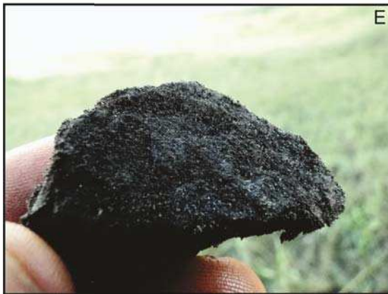
Figura 1 - Principais litotipos constatados na área de estudo: xisto do Grupo Nova Lima (A); quartzito da Formação Moeda (B); filito da Formação Batatal (C); filito da Formação Moeda (D); itabirito da Formação Cauê (E); fragmento de carapaça ferruginosa - canga (F).
