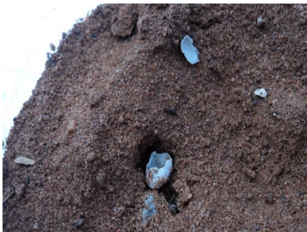
Figura 4. Imagem de grânulo do fertilizante revestido com polímero 1 (UP1) após 23 h de incubação. Após a abertura da “carapaça”, observa-se o interior do grânulo vazio, indicando a rápida dissolução da ureia revestida com esse material.
