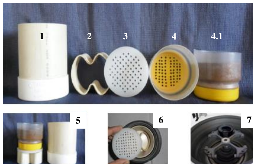
Figura 2. Estrutura do coletor de solução do solo. 1- tubo de PVC de 75 mm de diâmetro por 100 mm de altura; 2- anel interno, 25 mm de altura; 3- placa de Tecnil de 5 mm de espessura e 72 perfurações de 3,0 mm de diâmetro; 4- incubador de 250 mL com detalhe da tampa crivada; 4.1- incubador de 250 mL preenchido com 180 g de solo; 5- detalhes da disposição dos componentes dentro do tubo coletor; 6- detalhes da alocação dos componentes na caçamba da centrífuga; 7- encaixe da caçamba no eixo da centrífuga.
