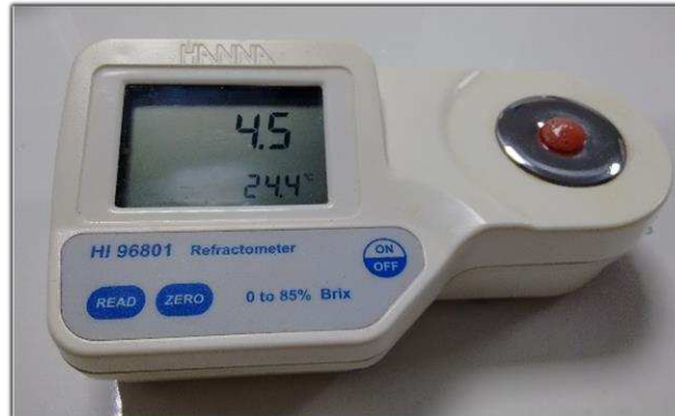
Figura 20. Medição do teor de sólidos solúveis totais com auxílio de refratômetro.
