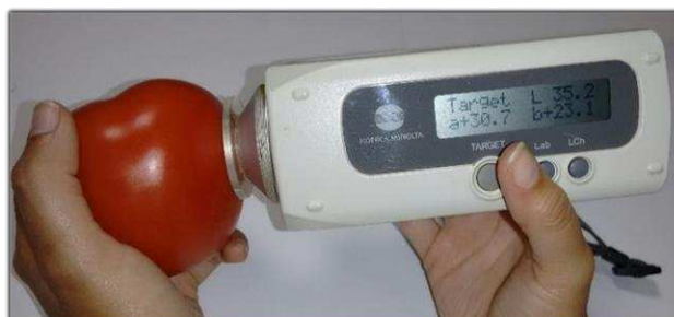
Figura 16. Medição dos parâmetros L , a e b com auxílio de um colorímetro.
