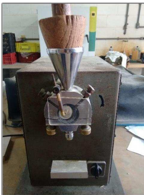
Figura 13. Moinho tipo Wiley utilizado para moagem das folhas do tomateiro.
