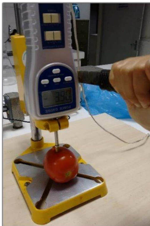
Figura 18. Avaliação da firmeza de fruto com auxílio de um penetrômetro.
