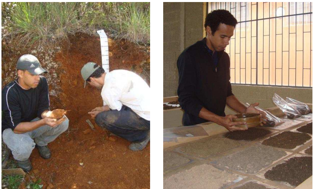
Figura 25. Descrição de perfil de solo no Parque Nacional do Caparaó, Minas Gerais-Espírito Santo, Brasil. Secagem e preparação de amostras para análises físicos e químicos.
