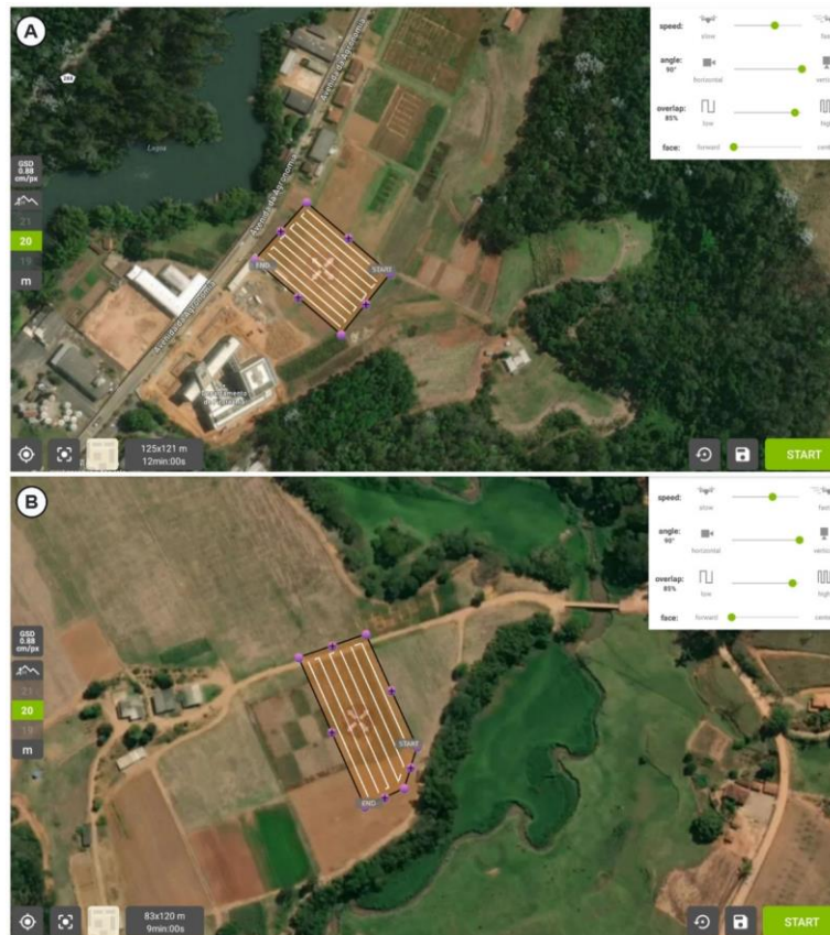
Figura 2. Representação dos planos de voo gerados pelo aplicativo Pix4D Capture para as áreas de estudo. A - Plano de voo elaborado para o Ensaio-1 (UEPE – Vale da Agronomia); B - Plano de voo elaborado para o Ensaio-2 (UEPE - Horta Nova).
