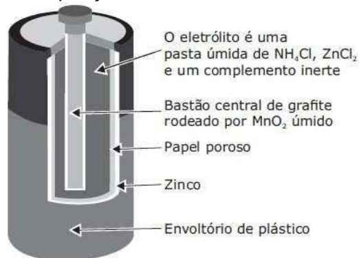
Figura 32: Pilha seca e sua composição.
