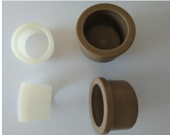
Figura 2: Porta amostra à esquerda e tampão de PVC à direita na foto, recipientes utilizados no experimento III.
