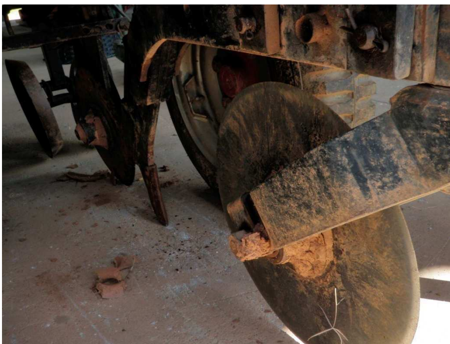
Figura 9 – Configuração “B” de montagem da linha de plantio (facão).
