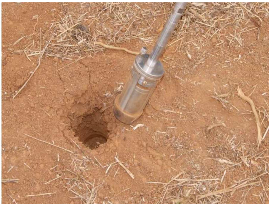
Figura 4 – Trado utilizado para coletar amostras indeformadas de solo.
