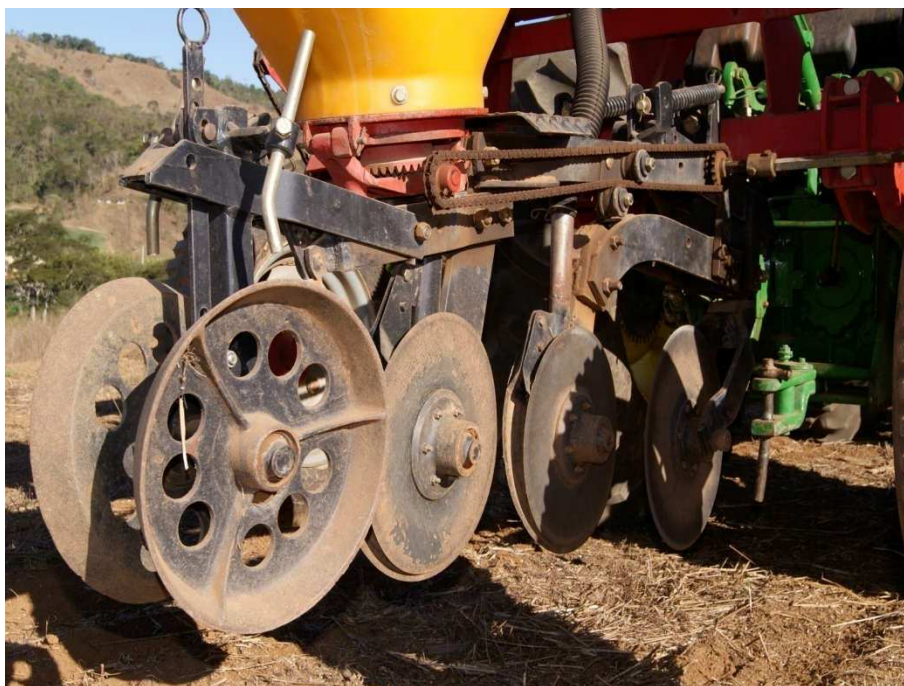
Figura 8 – Configuração “A” de montagem da linha de plantio (disco duplo defasado).
