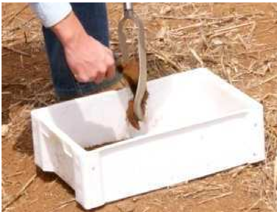
Figura 3 – Trado utilizado para coletar amostras deformadas de solo.
