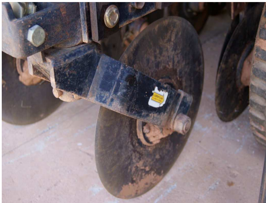
Figura 10 – Disco de corte utilizado nas duas configurações de montagem da linha de plantio (“A” e “B”).
