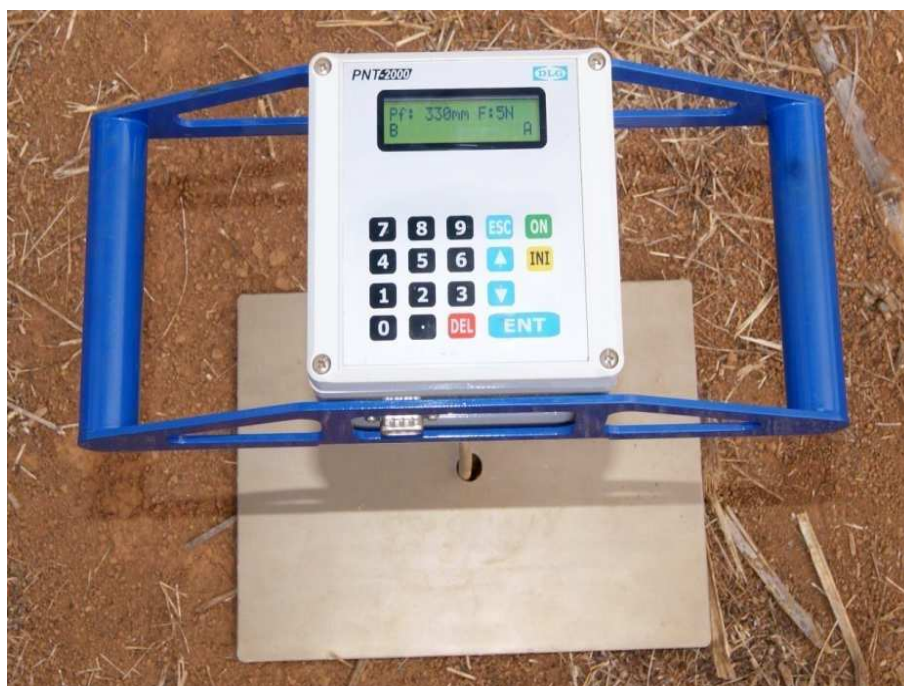
Figura 5 – Penetrômetro utilizado para medir a resistência do solo à penetração.
