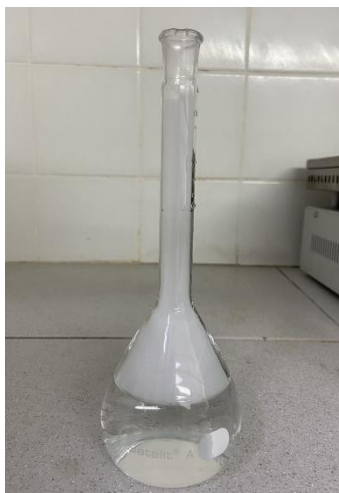
Figura 7. Vapor evidenciando volatilização de \text{NH}_3 durante a produção dos extratores (E-9 a E-22, ver tabela 3) contendo 250 mmol/L de \text{NH}_4\text{OH} .
