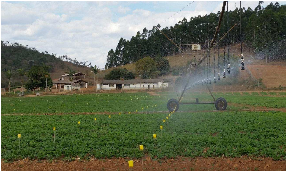
Figura 5. Ensaio de precipitação a campo com emissores de placa defletora rotativa oscilante.
