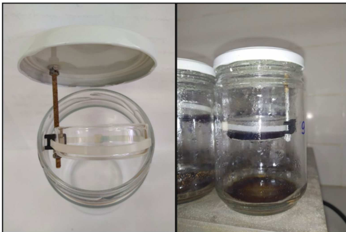
Figura 3. Detalhes da câmara de difusão mostrando as adaptações feitas na tampa para manter uma placa de Petri suspensa (a); câmara de difusão em aquecimento a 50 °C por 5 h em chapa aquecedora, após o tratamento de 1 g de solo com 10 mL de NaOH 2 mol L -1 e deposição de 5 mL da solução indicadora de H 3 BO 3 na placa de Petri.
