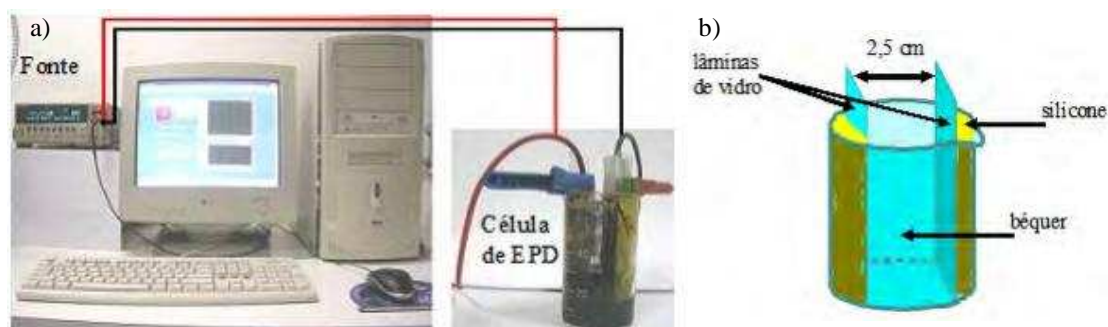
Figura 2.1: a) Montagem para a Deposição Eletroforética (EPD); b) Esquema da célula de EPD.
