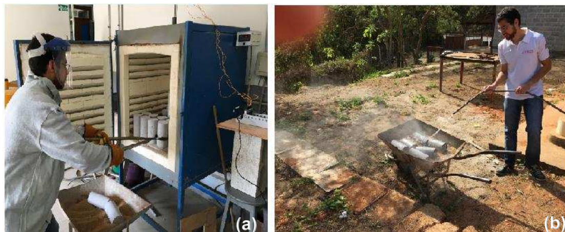
Figura 15 - Retirada dos CPs-FC do forno (a) e resfriamento rápido (b).
