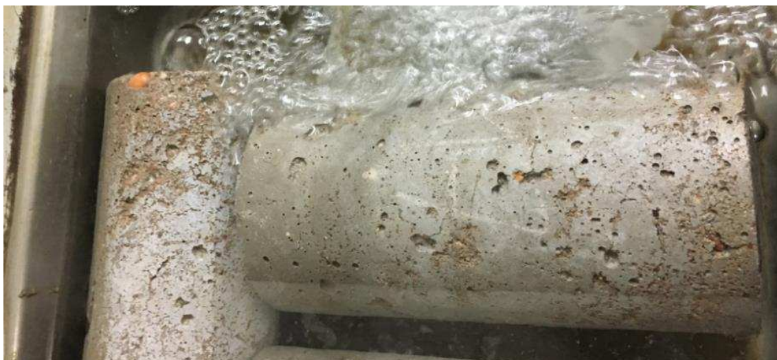
Figura 17 - Resfriamento (rápido) de um CP-FC/800 °C com surgimento de fissuras.
