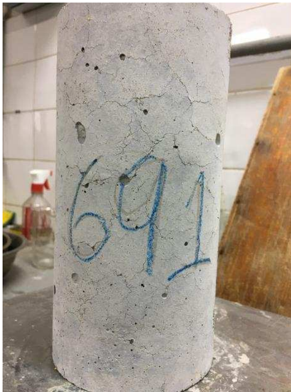
Figura 18 - Resfriamento (lento) de um CP-SC/800 °C com surgimento de fissuras.
