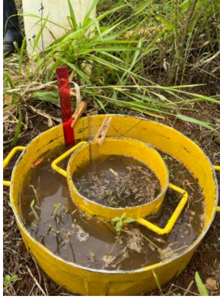
Figura 6 - Teste de infiltração de água no solo utilizando o Infiltrômetro de Anéis Concêntricos.
