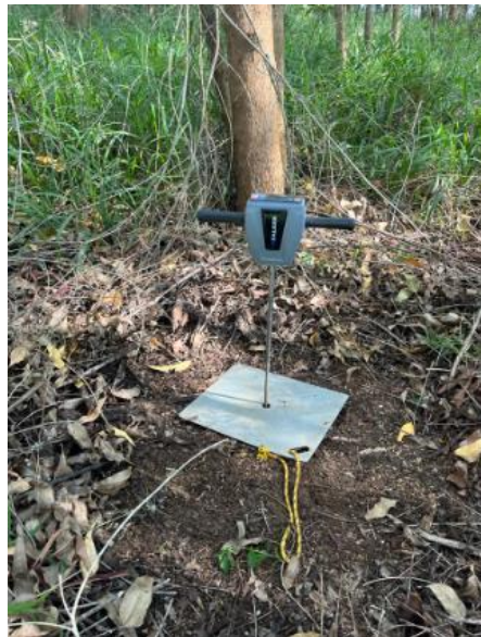
Figura 5 - Teste de resistência do solo à penetração.
