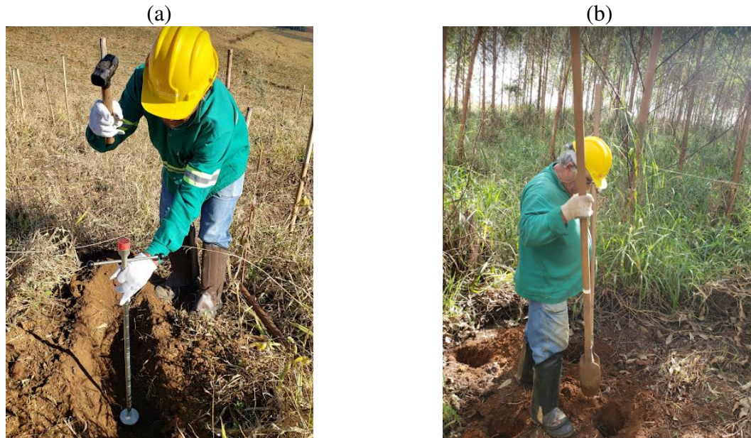
Figura 4 - Coletas de solo: a) amostra indeformada com amostrador de Kopeck ; e b) amostra deformada.
