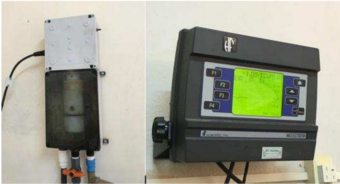
Figura 10. Sensor do medidor de carga (esquerda) e monitor do medidor de carga (direita).
