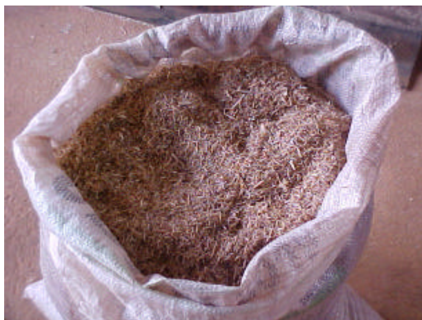
Figura 5: Detalhe do resíduo triturado e peneirado, pronto para uso como material filtrante das ARS
