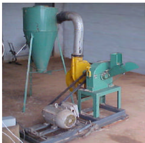
Figura 4: Equipamento utilizado p/ triturar o material a ser usado como filtro
