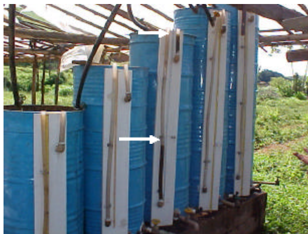
Figura 7: Determinação da perda de carga na coluna filtrante, obtida por meio de leitura da diferença de nível de líquido no piezômetro.
