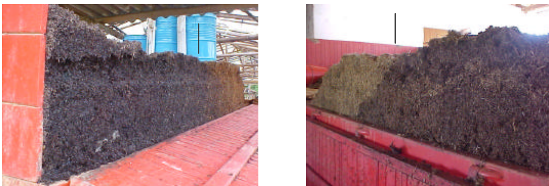
Figura 1: Detalhe da profundidade de penetração dos SS ao longo da camada filtrante à esquerda, filtro de serragem de madeira e à direita, filtro de bagaço de cana-de-açúcar.
