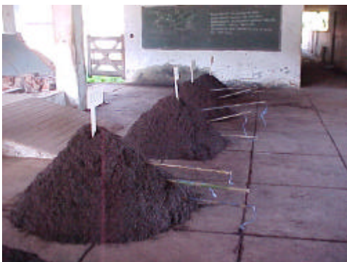
Figura 4: Sondas introduzidas no interior de cada pilha (base, centro e topo) para determinação da temperatura
