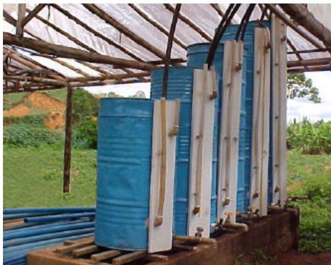
Figura 3: Colunas filtrantes de diferentes alturas usadas no tratamento de águas residuárias da suinocultura.
