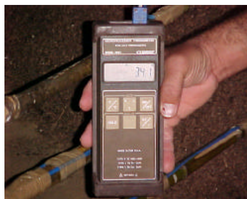
Figura 5: Termômetro digital utilizado para determinação da temperatura da massa
