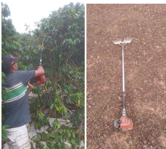
Figura 15 – (a) Trabalhador usando uma derriçadeira na colheita do café na região de Caiana -MG (b) derriçadeira
