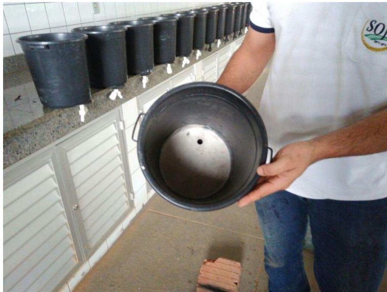
Figura 2: Nivelamento do fundo dos SACs, Viçosa – MG, 2017.
