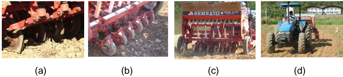
Figura 4 – Semeadora de plantio direto usada. (a) discos de corte da palhada; (b) rodas compactadoras; (c) detalhe de espaçamento entre linhas; (d) plantio propriamente dito.
