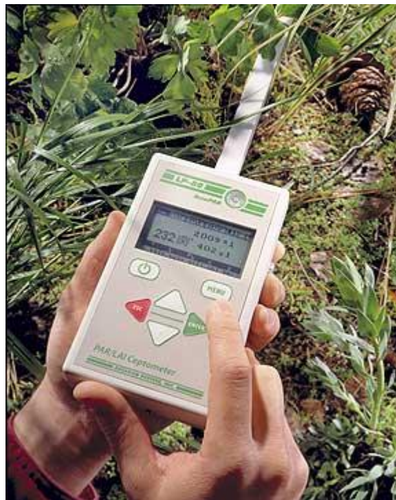
Figura 6 – Ceptômetro para obtenção de leituras medidas de radiação acima e abaixo do dossel da forrageira.
