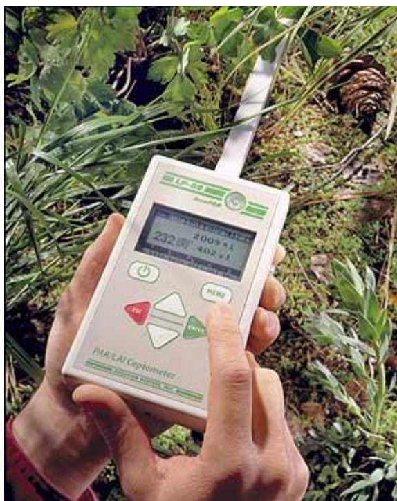
Figura 6 – Ceptômetro para obtenção de leituras de radiação acima e abaixo do dossel da forrageira.
