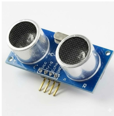
Figura 7.21: Sensor HC-SR04: Sensor Ultrassônico de distância - Fonte: Elaborada pela autora utilizando o modelo Gemini da Google (2025).
