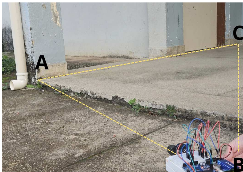
Figura 7.29: Medição do segmento \overline{AC} com o Arduino e sensor de distância para aplicação da Lei dos Senos. Fonte: Elaborada pela autora (2025).
