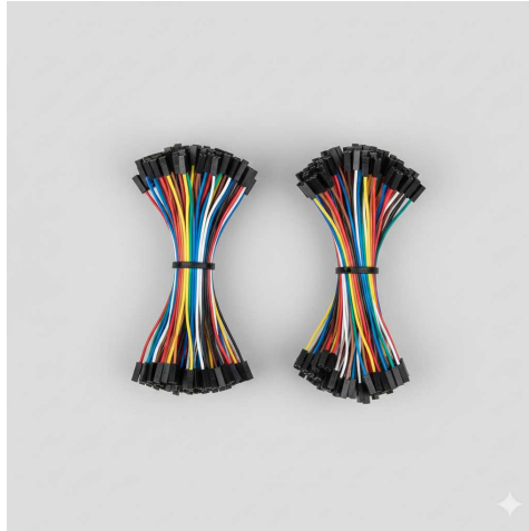
Figura 5.5: Fios jumpers. Fonte: Elaborada pela autora utilizando o modelo Gemini da Google (2025).
