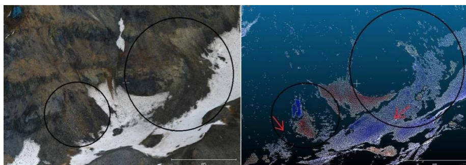
Figura 15 - À esquerda observa-se quedas de blocos influenciados pela presença de falhas e alta declividade e à direita atividade relacionada à presença de permafrost sob depósito de materiais finos. Em vermelho estão representadas áreas onde houve acúmulo de material e azul perda.
