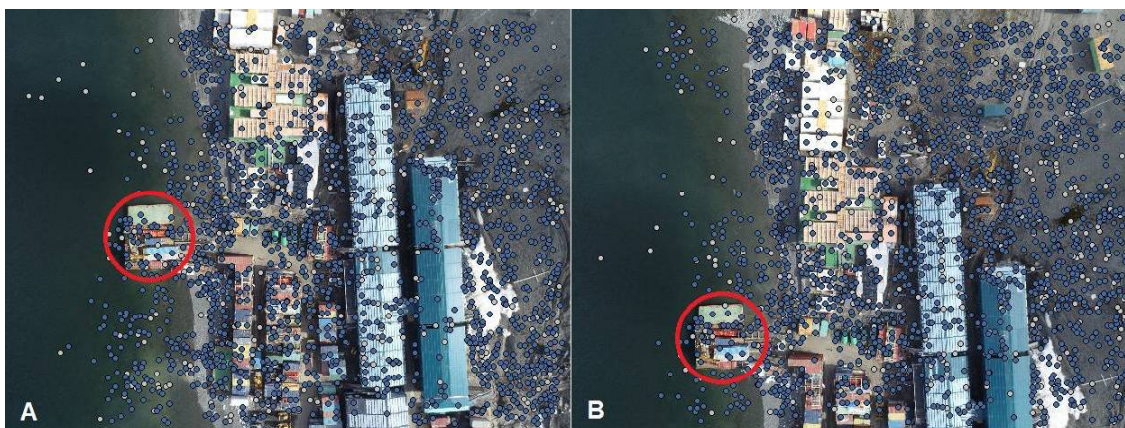
Figura 07 - Processo utilizado pelo algoritmo para a busca de pontos homólogos.
