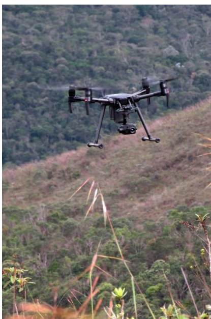
Figura 2. Imagem do drone DJI Matrice 200, equipado com uma câmera termal Zenmuse XT de resolução e uma câmera RGB de alta definição utilizados para o levantamento de fauna na RPPN de Capivary, Santa Bárbara, Minas Gerais, Brasil.
