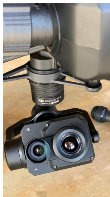
Figura 2. Imagem do drone DJI Matrice 200, equipado com uma câmera termal Zenmuse XT de resolução e uma câmera RGB de alta definição utilizados para o levantamento de fauna na RPPN de Capivary, Santa Bárbara, Minas Gerais, Brasil.
