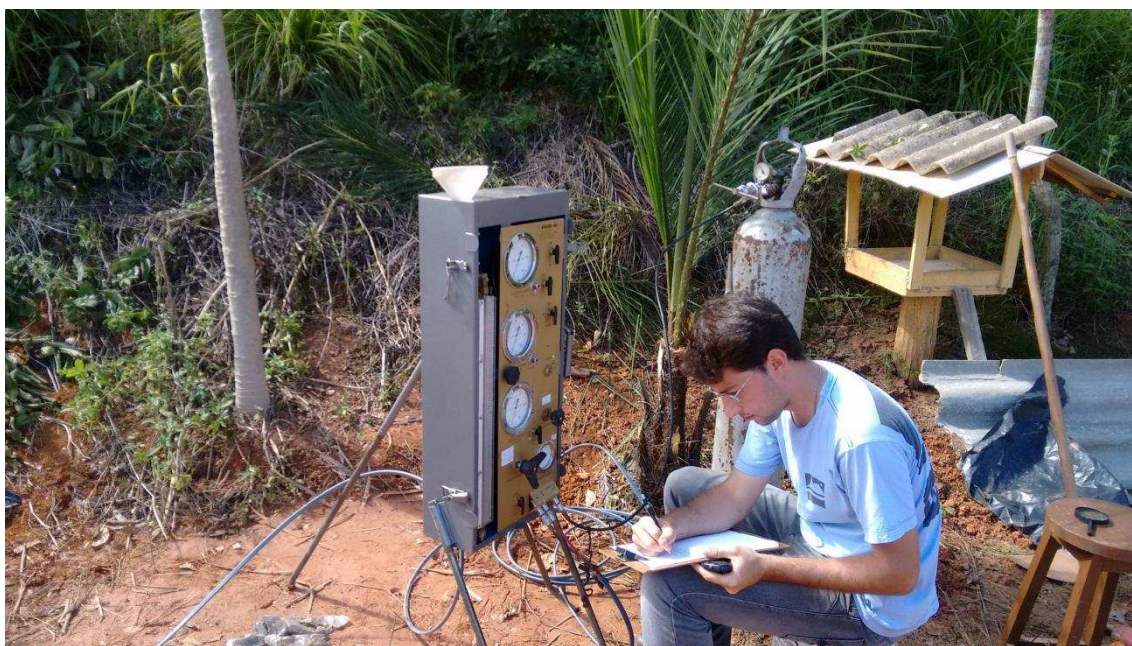
Figura 3.21 - Realização de leituras no volumímetro.
