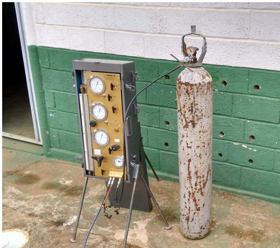
Figura 3.6 - Pressiômetro de Ménard do DEC/UFV.
