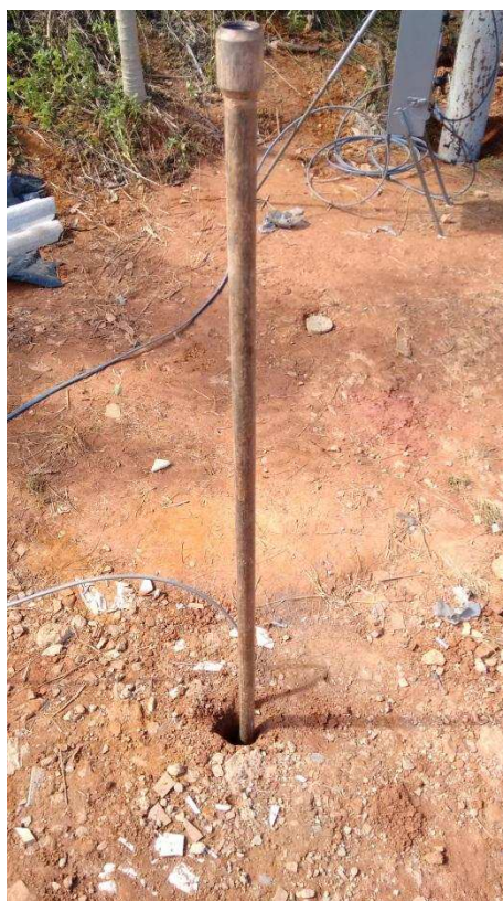
Figura 3.19 - Sonda pressiométrica inserida no furo.
