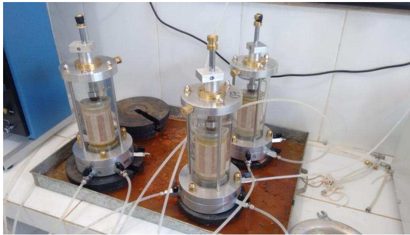
Figura 3.35 - Saturação por percolação.
