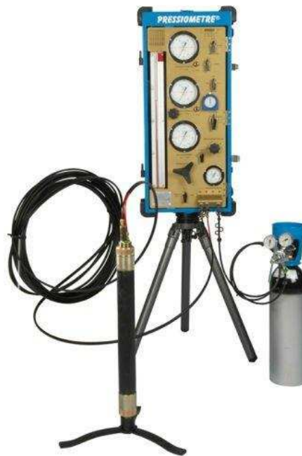
Figura 2.3 - Pressiômetro de Ménard do tipo GC.
