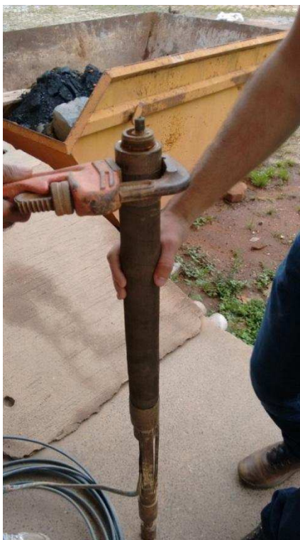
Figura 3.9 - Saturação da sonda pressiométrica.
