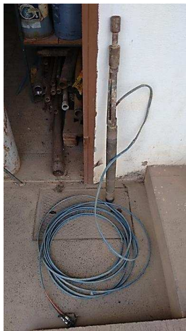
Figura 3.8 - Sonda pressiométrica e mangueiras de conexão.
