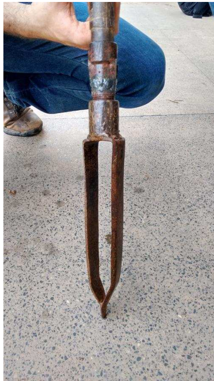
Figura 3.15 - Trado utilizado na execução dos furos.
