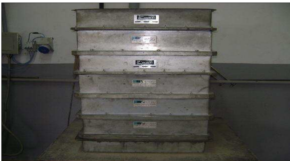
Figura 8: Detalhe do conjunto de peneiras utilizado na separação granulométrica do meio suporte e parte do material orgânico aderido ao meio suporte.
