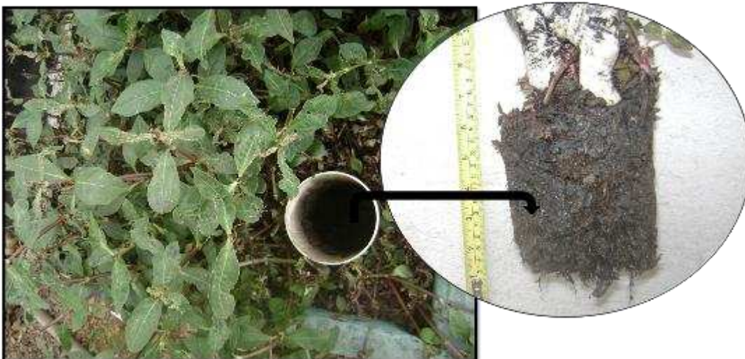
Figura 15: Amostra extraída a partir da camada superficial do leito do SAC-EHSS cultivado com alternantera.
