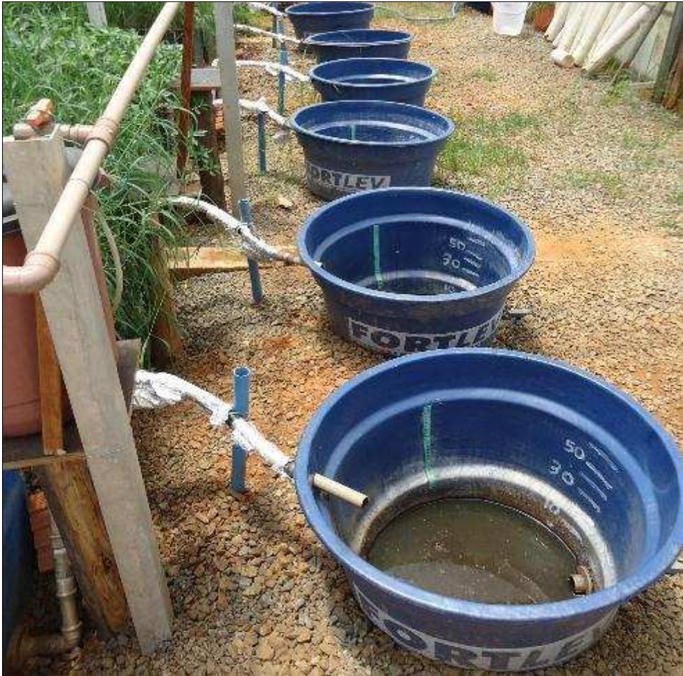
Figura 5: Detalhe da instalação das caixas de polietileno graduadas utilizadas para medição da perda de água nos sistemas por evaporação ou evapotranspiração.
