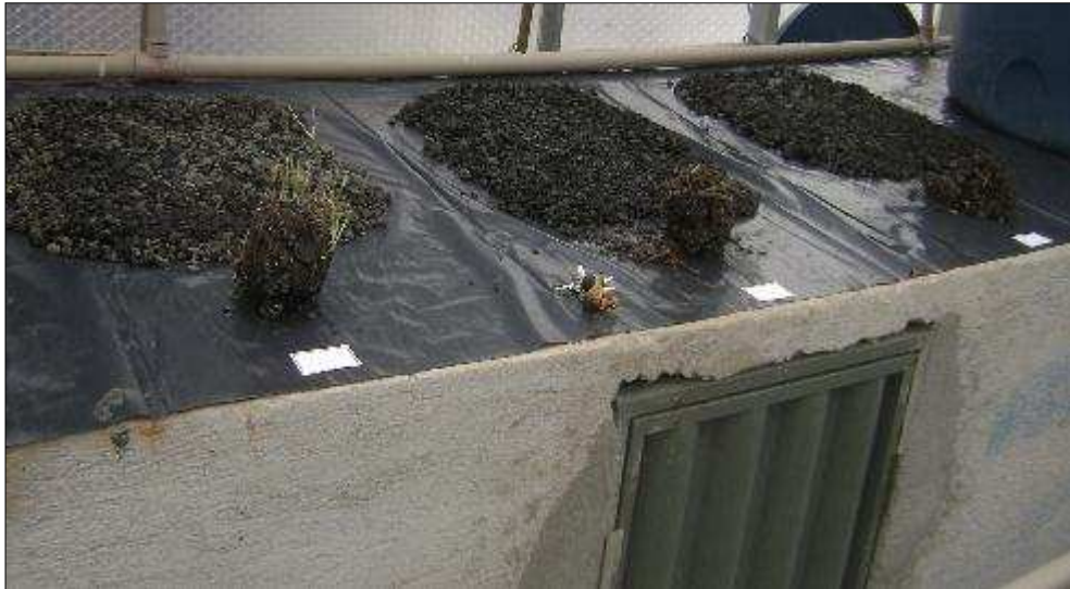
Figura 7: Detalhe do material coletado no meio filtrante dos SACs-EHSS em processo de secagem sobre a bancada.
