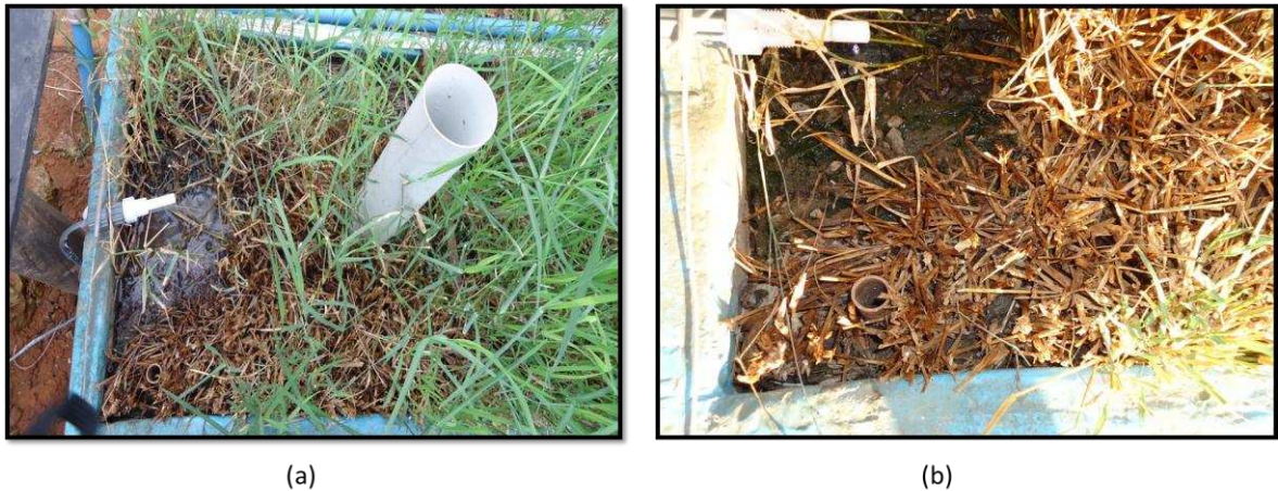
Figura 24: Presença (a) e ausência (b) de escoamento superficial nos leitos dos SACs-EHSS cultivados com tifton.
