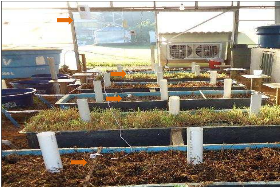
Figura 4: Detalhe da instalação dos termômetros no meio poroso dos SACs-EHSS.
