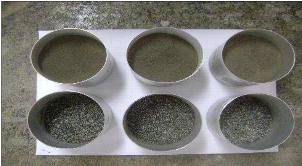
Figura 10: Divisão do material a ser analisado. Na parte cima, o denominado “material fino” e na parte de baixo o “material grosseiro”.
