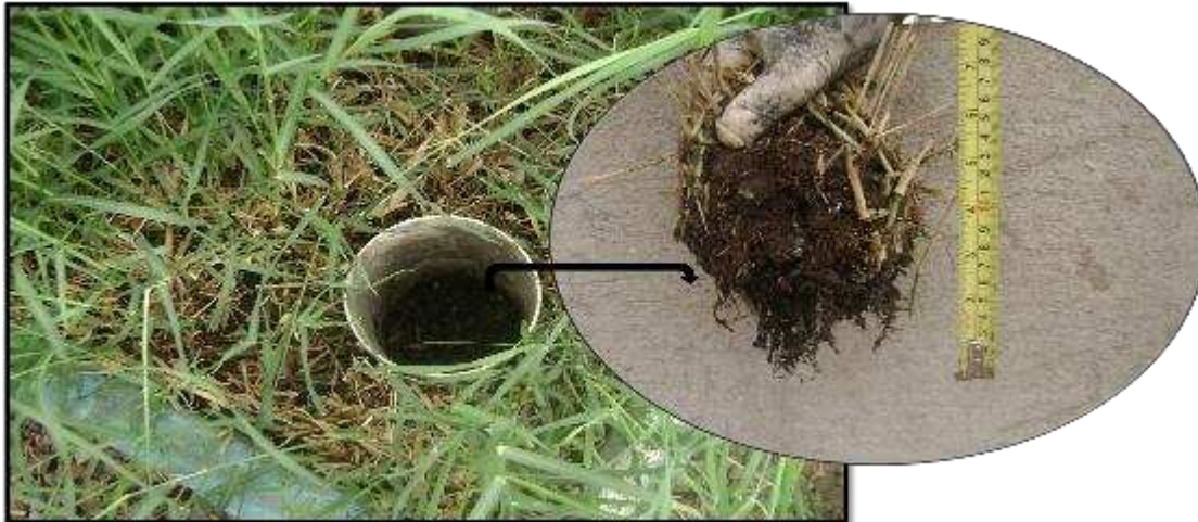
Figura 14: Amostra extraída a partir da camada superficial do leito do SAC-EHSS cultivado com o capim tifton 85.
