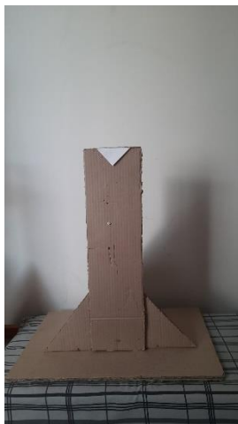
Figura 8 - Coluna conectada ao suporte
