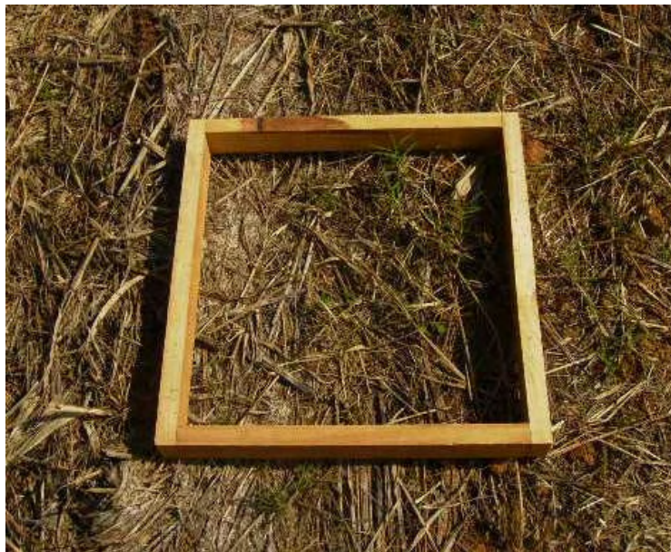
Figura 13 - Quadro de madeira utilizado para a coleta da massa da cobertura vegetal
