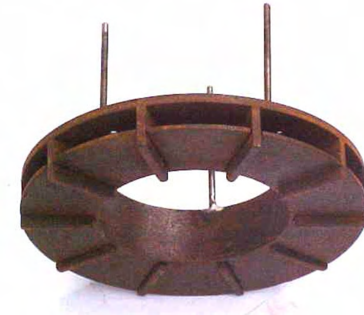
Figura 6 – Mecanismo dosador de fertilizantes da adubadora puncionadora desenvolvido por Yamamoto (2005) e Villibor e Loureiro (2006).
