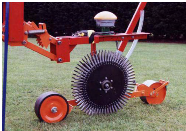
Figura 2 – Semeadora de precisão, em covas, constituídas por discos em “V” desenvolvida por Resende (2002)
