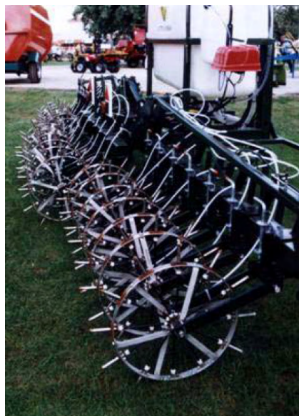
Figura 1 – Mecanismo distribuidor de fertilizantes líquido de forma pontual, desenvolvido por Baker (1989)
