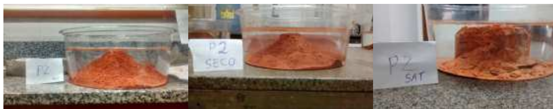
(a) Condição de umidade natural (b) Condição de umidade seca (c) Condição de umidade inundada
