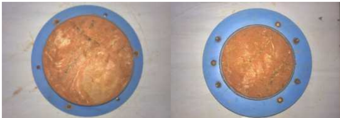
(a) Fixação do anel amostrador com o corpo de prova e a base do amostrador
