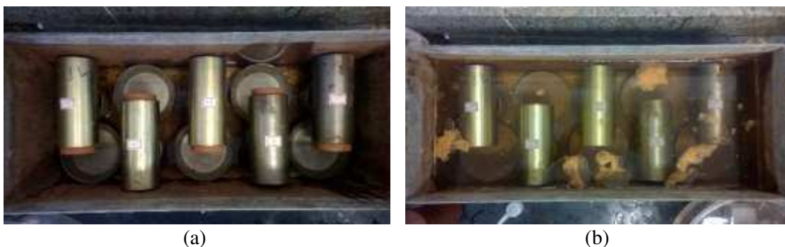
Figura 10 – Ensaio de perda de massa por imersão: (a) corpos de prova antes da imersão em água; e (b) corpos de prova durante a imersão em água.
