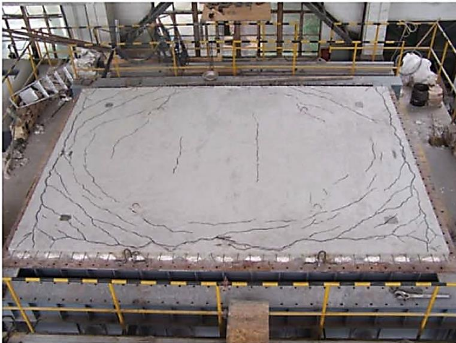
(b) Padrão de fissuras no modelo experimental.
