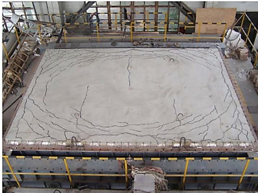
(b) Padrão de fissuras no modelo experimental.
