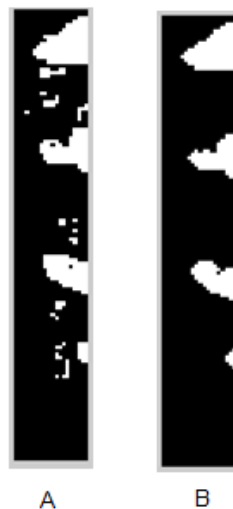
Figura 2.17 – A: Imagem apresentando ruídos; B: Eliminação dos ruídos na imagem após a aplicação do processo de abertura
