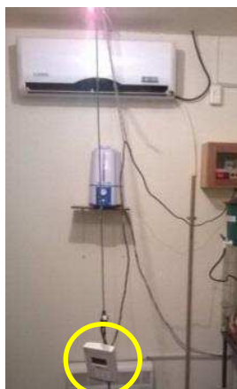
Figura 2.6 – Datalogger utilizado para a coleta de dados de temperatura e umidade relativa do ar
