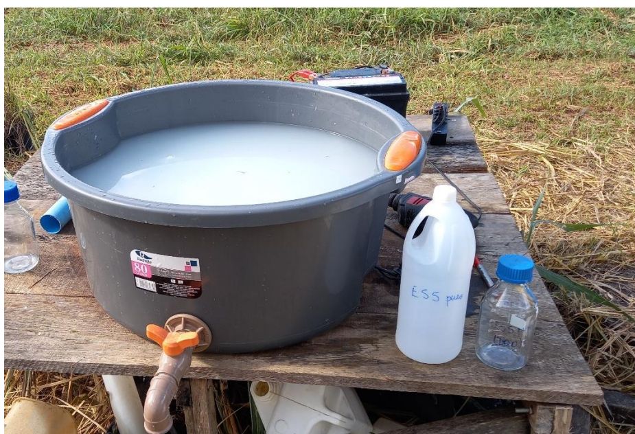
Figura 6 – Esgoto sanitário sintético (ESS) usado para reposição das lâminas evapotranspiradas nos TEvap. Experimento – etapa 2 (capítulo 4). Rio Pomba - MG, 2021. Fonte: a autora.
