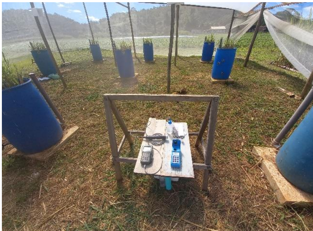
Figura 7 - Multiparâmetro e turbidímetro usados na medição do pH, condutividade elétrica e turbidez na solução dos TEvap e no esgoto sanitário sintético. Experimento – etapa 2 (capítulo 4). Rio Pomba - MG, 2021. Fonte: a autora.
