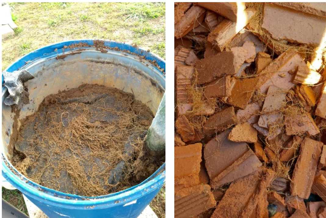
Figura 3 – Presença de raízes na manta geotêxtil usada para separar as camadas e entre as lajotas da primeira camada do TEvap. Fotos da desmontagem do experimento - etapa 1 (capítulo 3). Rio Pomba - MG, 2020. Fonte: a autora.
