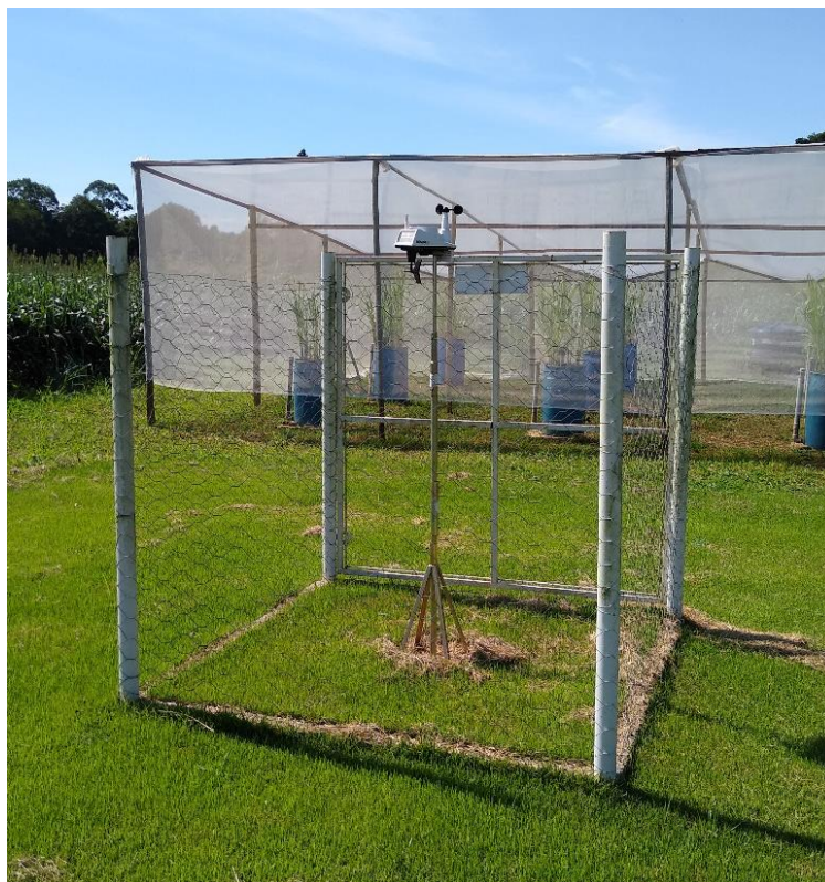
Figura 9 – Miniestação meteorológica automática instalada ao lado do experimento em casa de vegetação. Rio Pomba - MG, 2021. Fonte: a autora.
