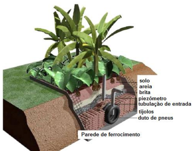
Figura 2.1 - Corte transversal de um TEvap mostrando suas diversas camadas e detalhes construtivos. Fonte da imagem: Paulo et al. (2013). Tradução da autora.
