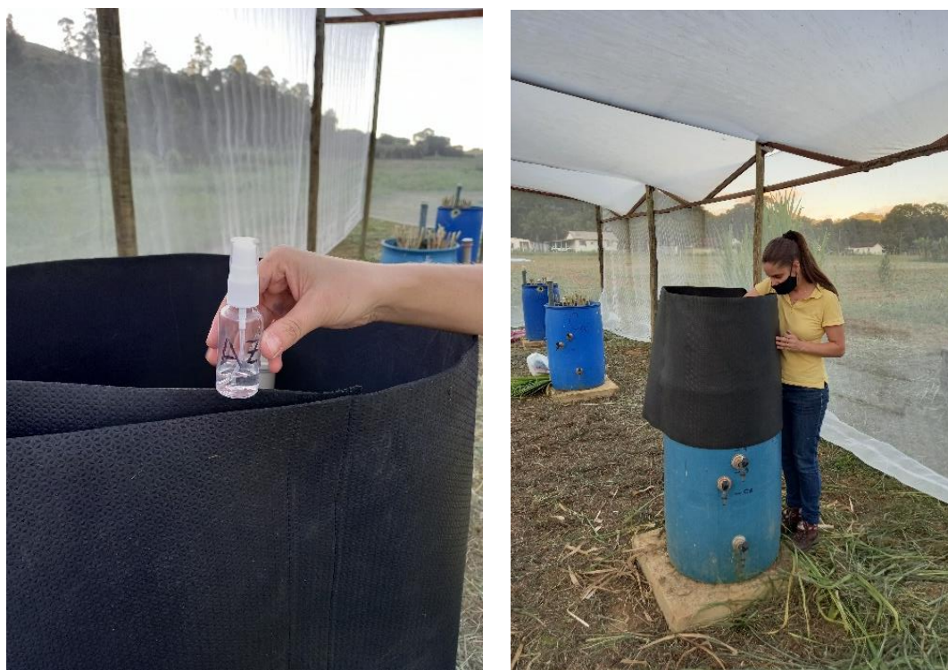
Figura 4. Frasco pulverizador usado na inoculação dos TEvap com as bactérias e aplicação dos microrganismos logo após o corte usando um protetor para evitar a deriva. Experimento – etapa 2 (capítulo 4). Rio Pomba - MG, 2021. Fonte: a autora.
