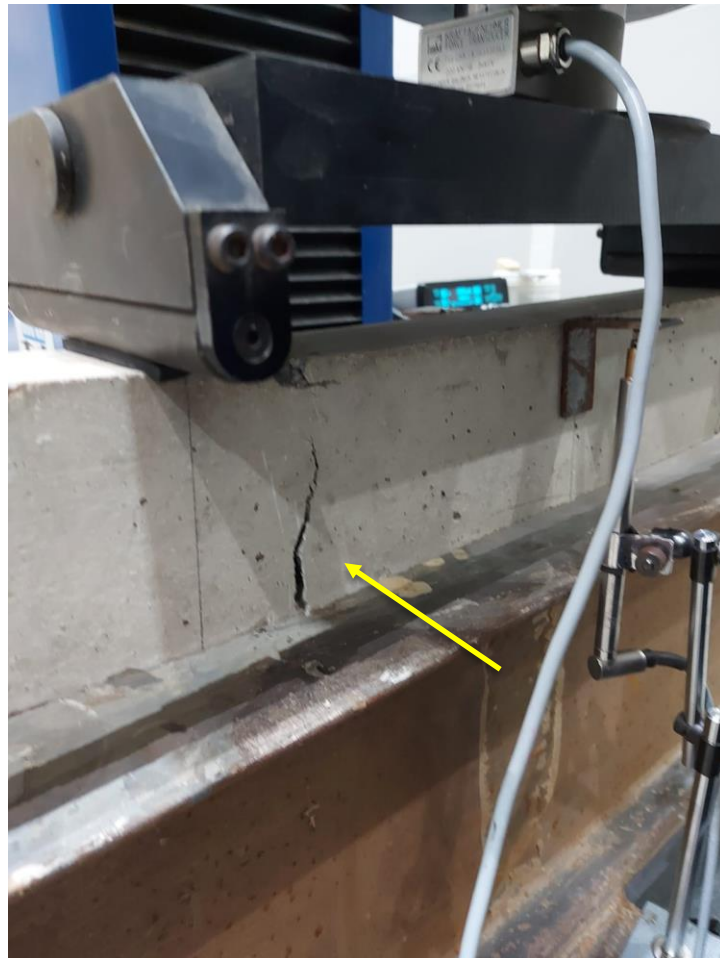
Figura 4.12: Ruptura viga V10
