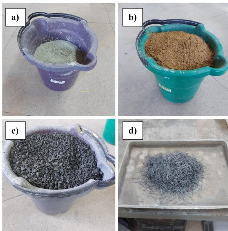
Figura 3.14: Materiais utilizados no preparo do CRF (a) cimento, b) areia natural, c) brita 0 e d) fibras de aço)
