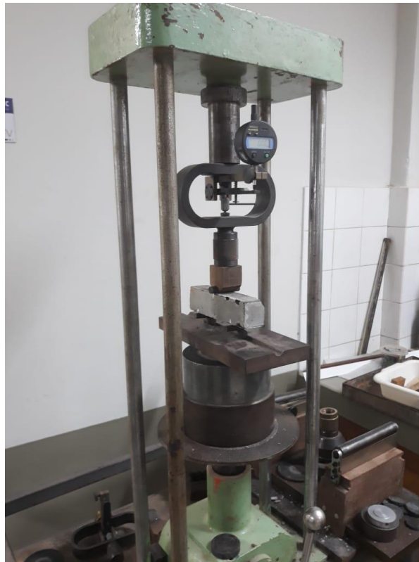
Figura 3.15: Ensaio de flexão a 3 pontos em CP prismático
