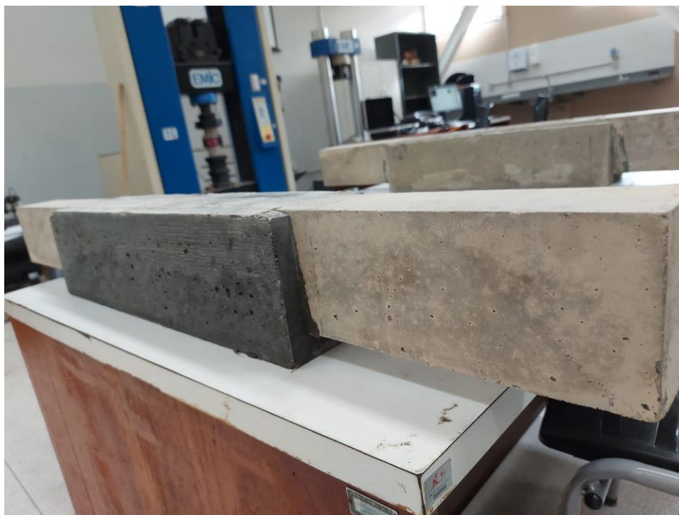
Figura 4.8: Vigas reforçadas com CPR e CRF em sua região fletida
