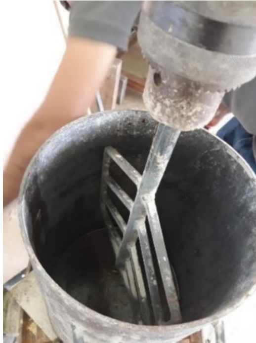
Figura 3.8: Misturador vertical com capacidade de 20 L utilizado na produção do CPR
