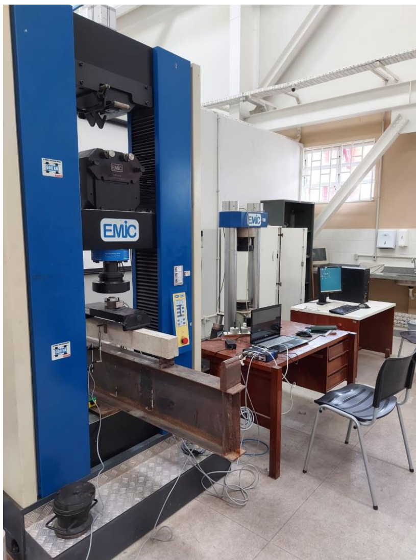
Figura 3.18: Montagem do ensaio na EMIC DL60000
