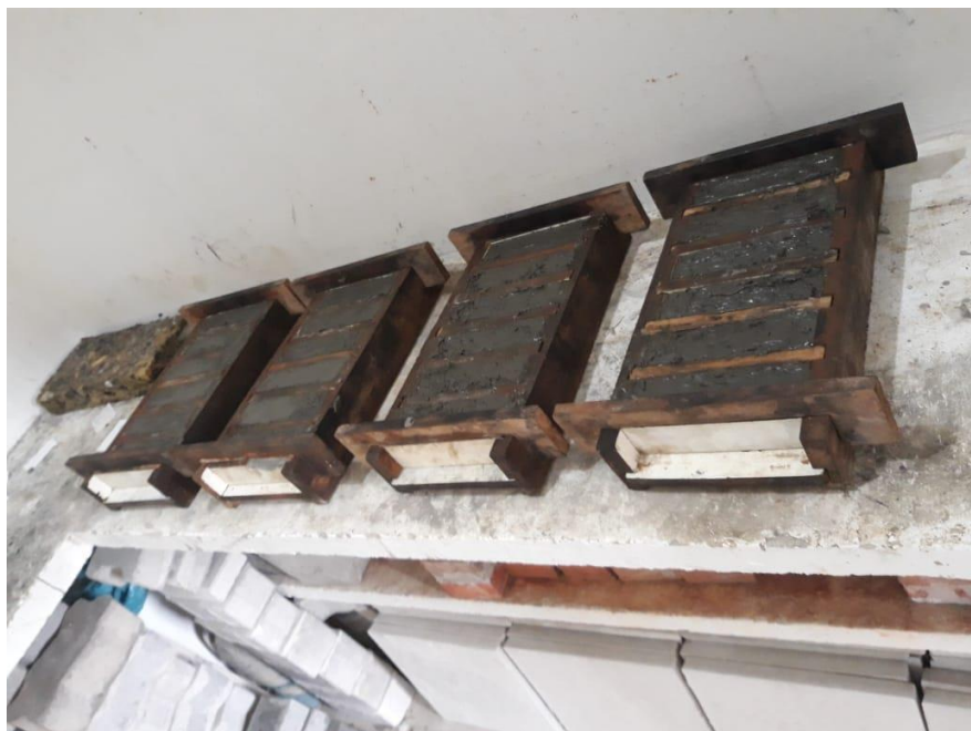
Figura 3.9: Corpos de prova prismáticos moldados
