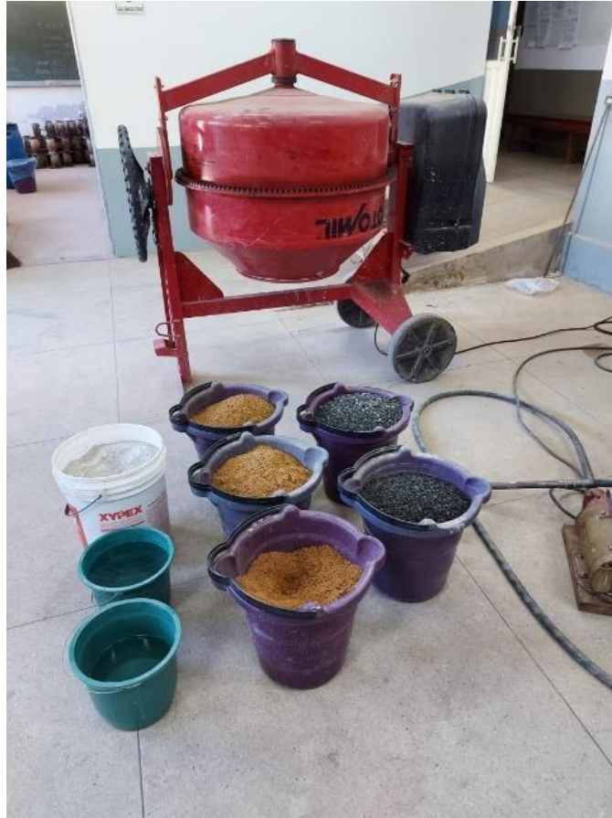
Figura 3.4: Materiais preparados para a produção do concreto convencional
