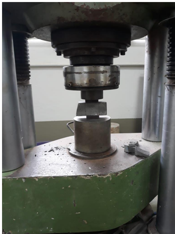
Figura 3.16: Ensaio de compressão em CP prismático
