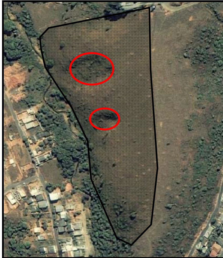
Figura 4.10 – Talude convexo com presença de movimentos gravitacionais de massa côncavos.
