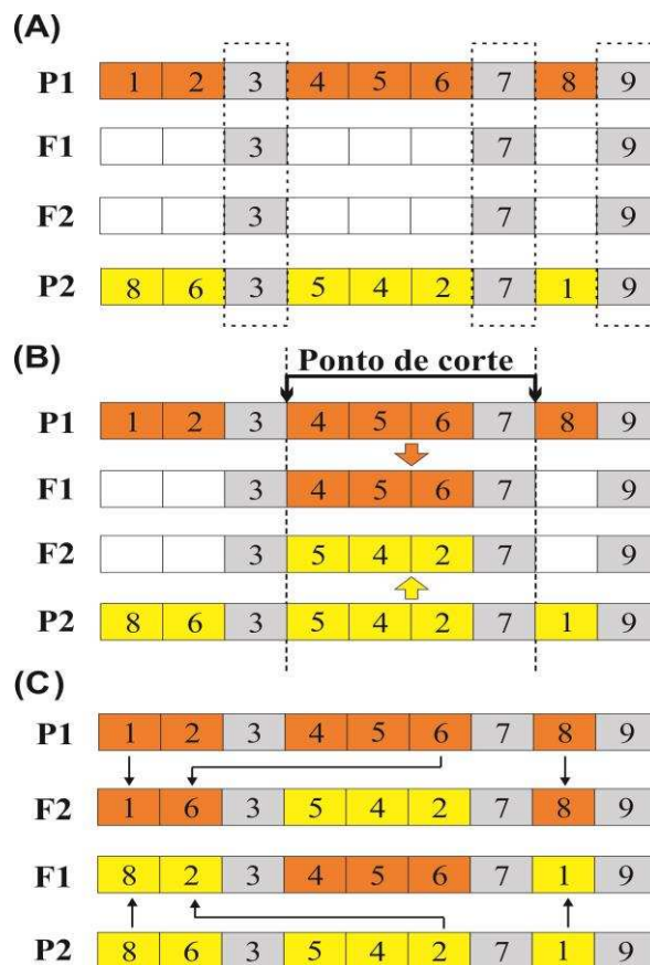
Figura 21: Cruzamento pelo operador SB2OX – (a) em primeiro lugar, as tarefas comuns em ambos os pais são copiadas para os filhos (cor cinza); (b) em seguida, as tarefas do ponto de corte são herdadas do pai para os filhos (c) as tarefas faltantes são copiadas em ordem do outro progenitor.
