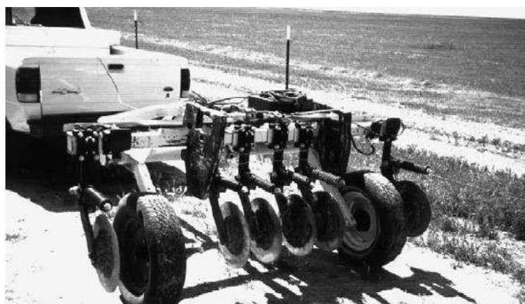
Figura 2.3. Sensor de resistividade elétrica do solo Veris 3100 (CORWIN; LESCH, 2005).
