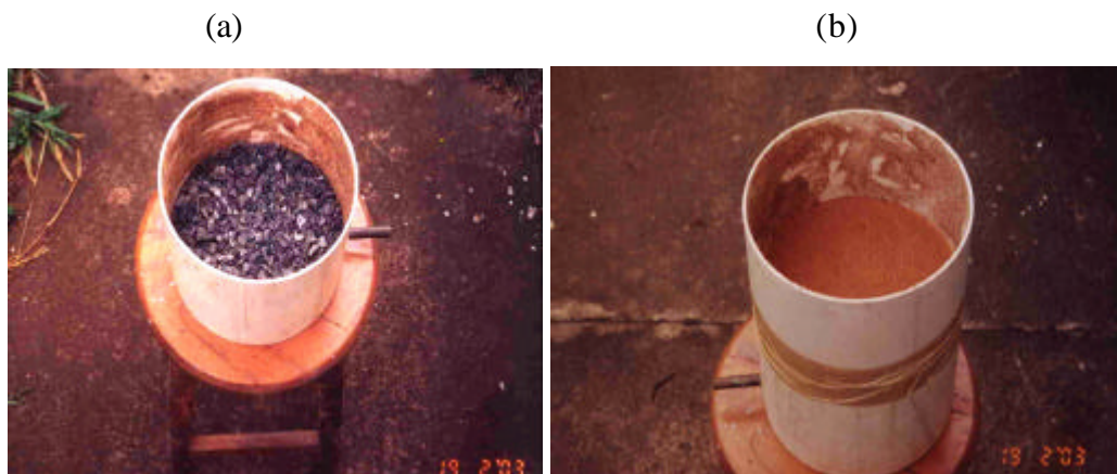
Figura 4 – Detalhes da montagem das colunas, a figura (a) mostra a deposição de brita e a figura (b) mostra a união de dois anéis de PVC.
